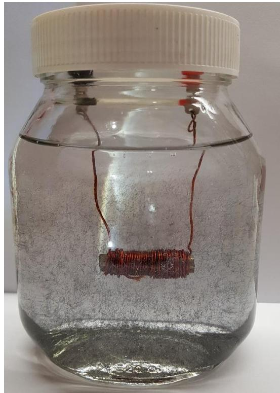
Slika 22 Zavojnica u mineralnom ulju s usitnjrenom čeličnom piljevinom
