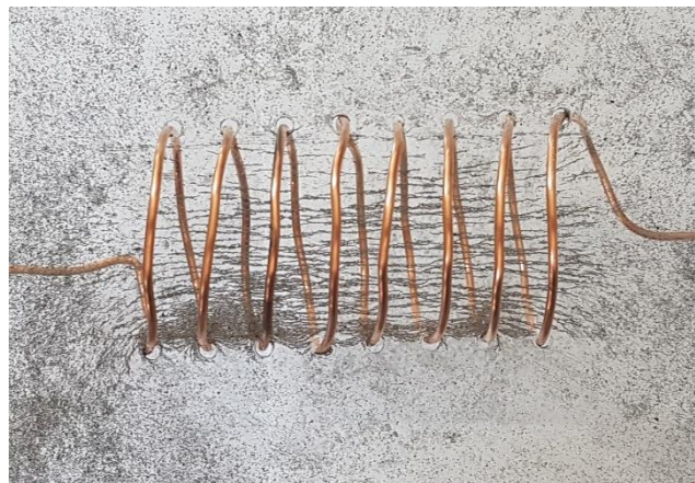
Slika 21 Silnice magnetskog polja dobivene pomoću željezne piljevine
