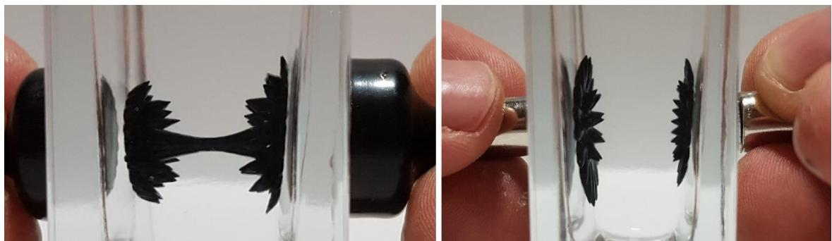
Slika 14 Privlačenje magneta (lijevo), odbijanje magneta (desno)
