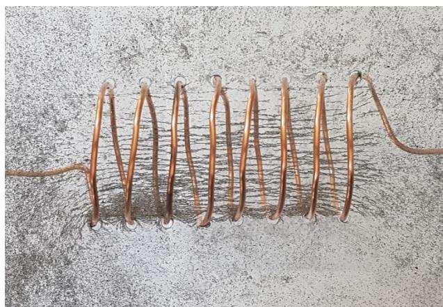
Slika 21 Silnice magnetskog polja dobivene pomoću željezne piljevine
