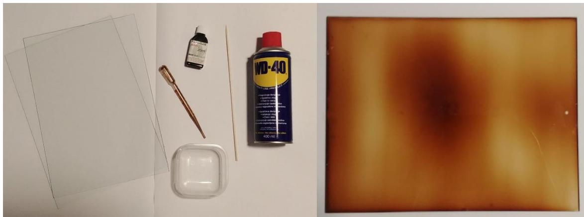
Slika 7 Pribor potreban za izradu dijela 3 (lijevo), konačan izgled stakla nakon dvadeset i četiri sata (desno)
