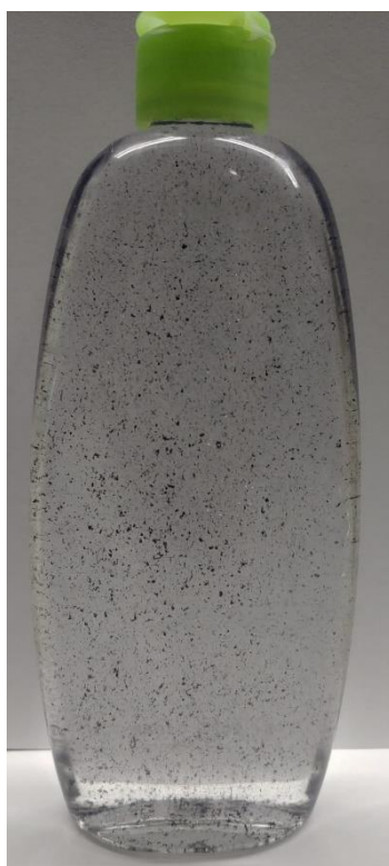
Slika 25 Željezna piljevina u plastičnoj boci
