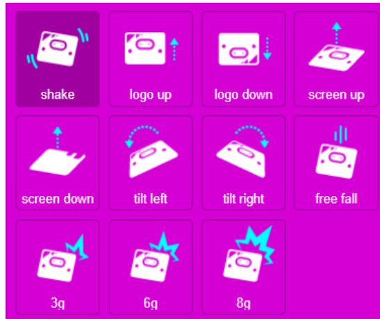
Slika 22 Geste koje micro:bit prepoznaje na temelju mjerenja akcelerometra.
