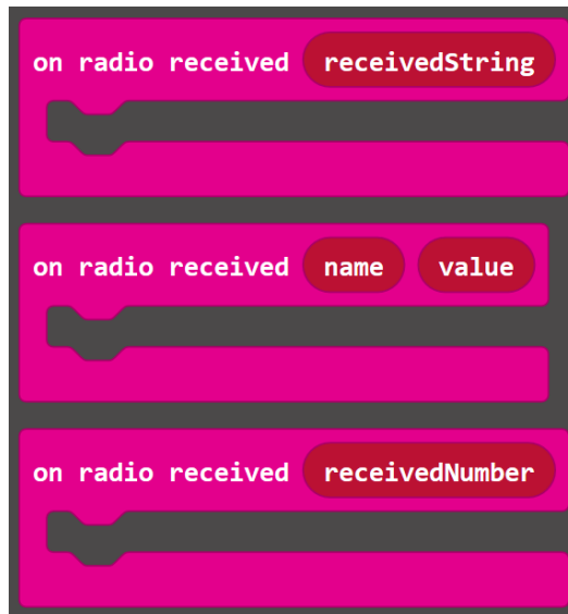
Slika 11 Primanje radio komunikacijom različitih tipova podataka
