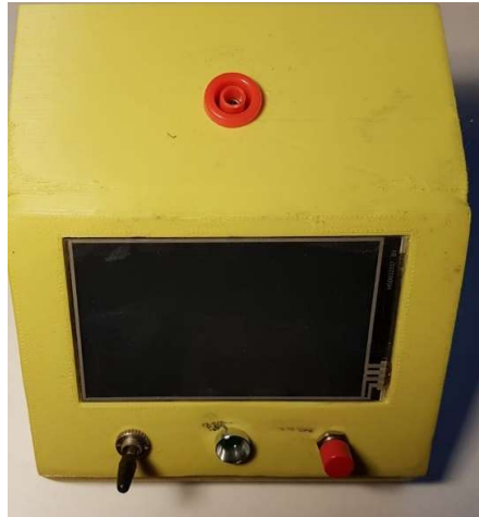
Slika 31 Izgled kulonmetra nakon 2. koraka
