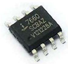
Slika 22 ICL7660 inverter napona
