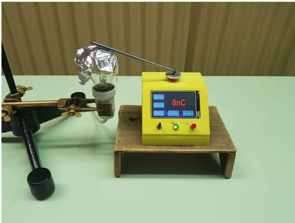
Slika 40 Postav pokusa "Termoelektronska emisija"
