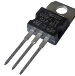
Slika 20 Linearni regulator napona 7805 - TO220 paket
