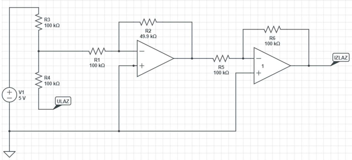
Slika 18 Shematski prikaz invertirajućeg pojačala s omskim zbrajalom i dodatnim invertirajućim pojačalom
