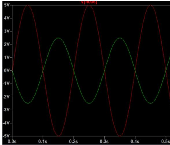
Slika 14 Grafički prikaz signala invertirajućeg pojačala (crveno-ulaz, zeleno-izlaz)
