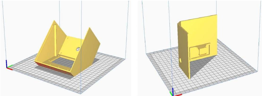
Slika 28 Orientacija printanja dijelova kućišta (baza-lijevo, poklopac-desno)
