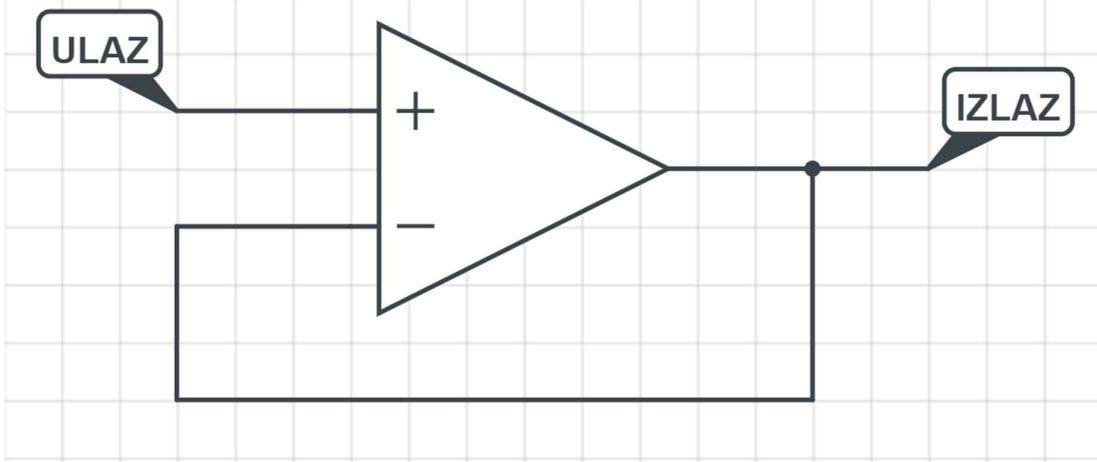
Slika 4 Shematski prikaz naponskog slijedila s operacijskim pojačalom
