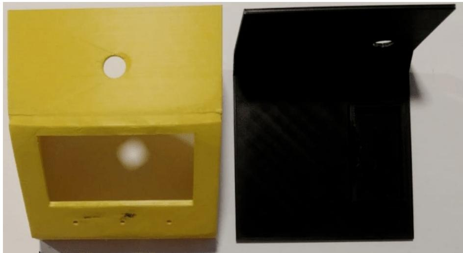
Slika 29 Isprintani dijelovi kućišta (baza-ljevo, poklopac-desno)
