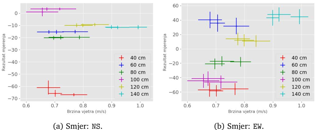
Slika 3.3: Kalibracijska mjerjenja odradena u prvom tunelu. Brzine vjetra mjerene referentnim anemometrom nalaze se na apscisi, a kalibracijska mjerjenja načinjena izrađenim anemometrom na ordinati (dana bezdimenzionalno). Boje označavaju mjerjenja napravljena na različitim udaljenostima od kraja tunela.
