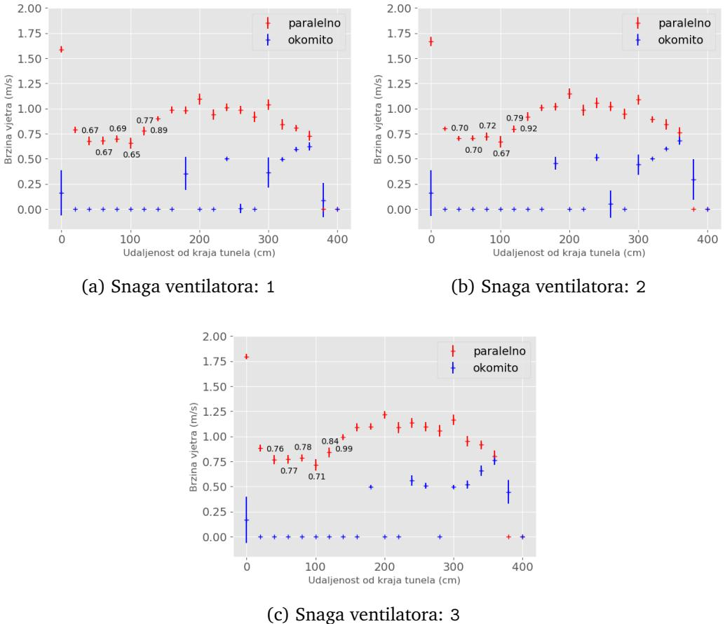
Slika 3.2: Mjerenja brzine unutar prvog tunela načinjena referentnim anemometrom. Prikazana su mjerenja načinjena paralelno smjeru protoka zraka kroz tunel (tj. duž tunela) i okomito na taj smjer. Mjerenja načinjena okomito smjeru strujanja zraka ne odgovaraju stvarnom stanju kako je objašnjeno u tekstu. Dane su numeričke vrijednosti brzine na mjestima koja su korištena za kalibracijska mjerenja.
