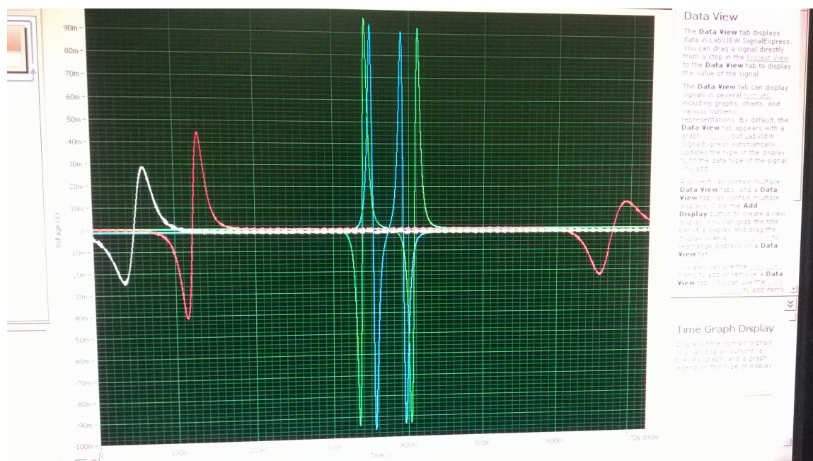
Slika 2.5: Graf ovisnosti induciranog napona o vremenu na četiri zavojnice.
