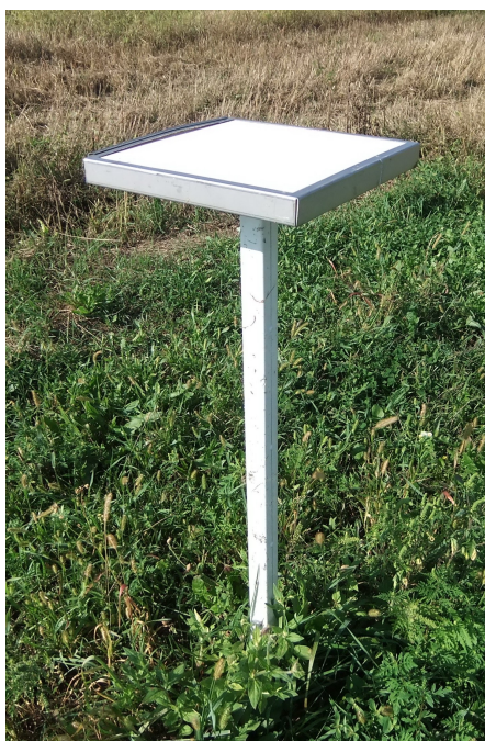
(a) Tučomjer (stalak i ploča)
