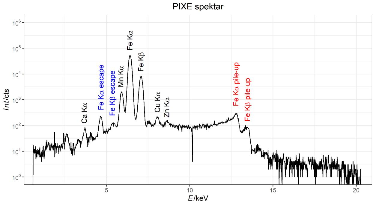
**Slika 1.8.** Primjer PIXE spektra s karakterističnim dijelovima.
