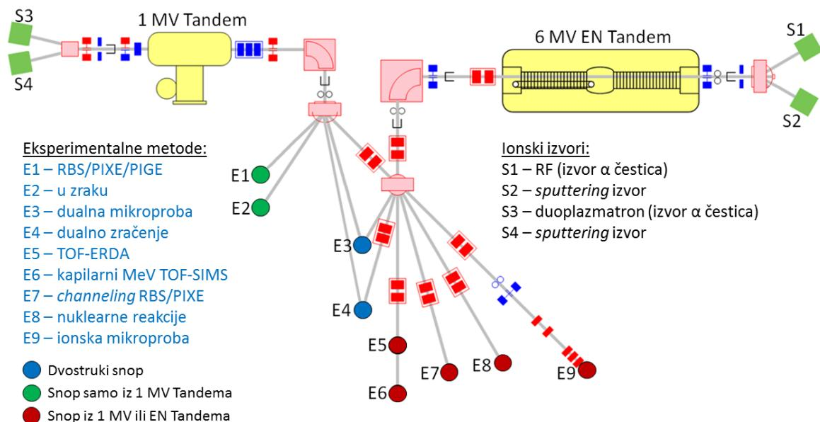
**Slika 2.10.** Shema eksperimentalnih linija u Laboratoriju za interakcije ionskih snopova na Institutu Ruđer Bošković u Zagrebu [166] (prilagođeno). Za potrebe ovog rada korišteni su izvor S4, Tandem akcelerator i komora E1.
