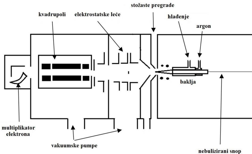
Slika 1.10. Shematski prikaz ICP-MS tehnike. Izvor: [154], prilagođeno.
