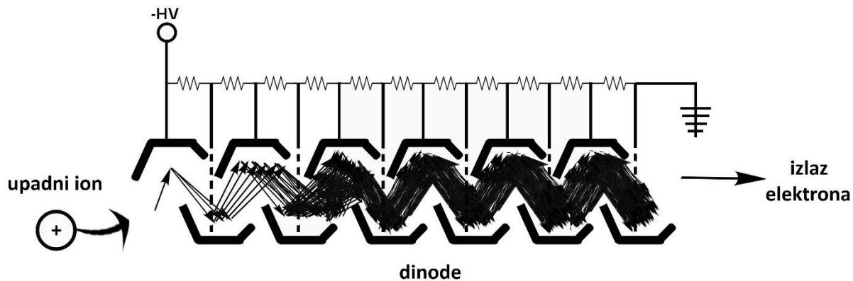
**Slika 1.11.** Shematski prikaz multiplikatora elektrona. Izvor: [155], prilagodeno.
