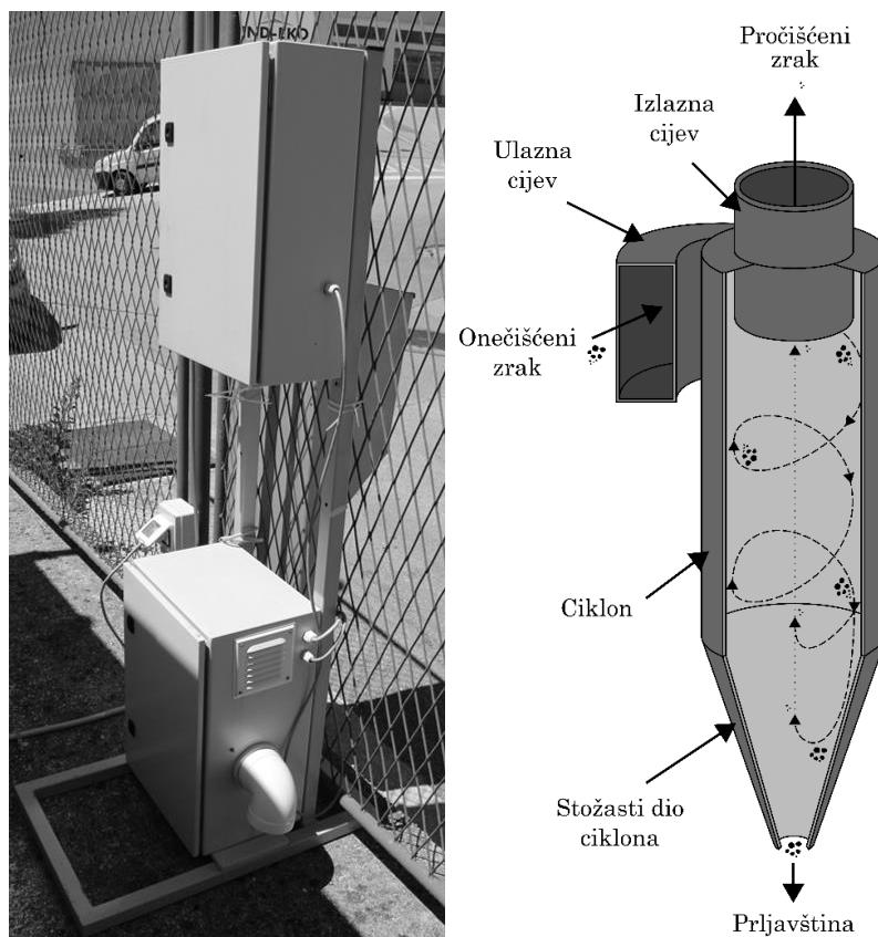
Slika 2.1. Ciklonski uzorkivač lebdećih čestica i shematski prikaz ciklonskog odvajača čestica. Izvor: [157], prilagođeno.
