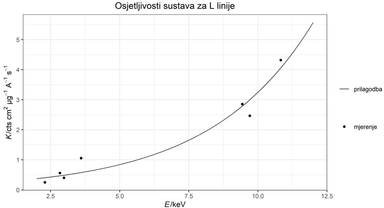
**Slika 2.8.** Izmjerene i prilagođene vrijednost osjetljivosti za L linije u ovisnosti o rednom broju elementa.
