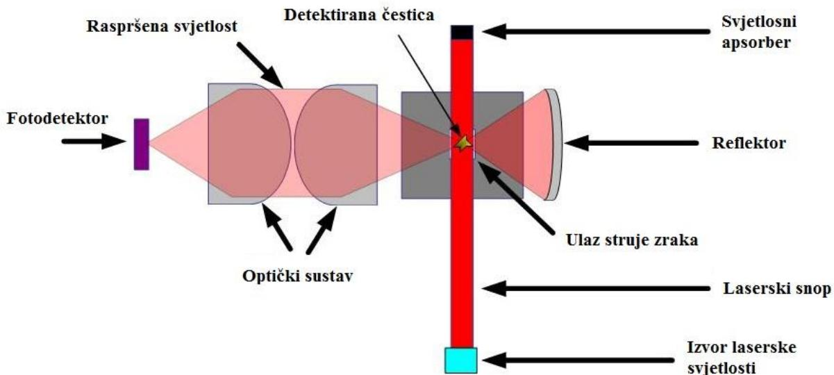
Slika 2.2. Shematski prikaz optičkog uzorkivača čestica, prema [158].
