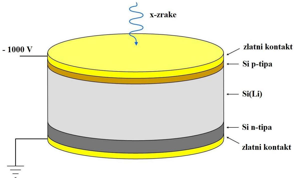
**Slika 1.4.** Shematski prikaz Si(Li) detektora, prema [146].
