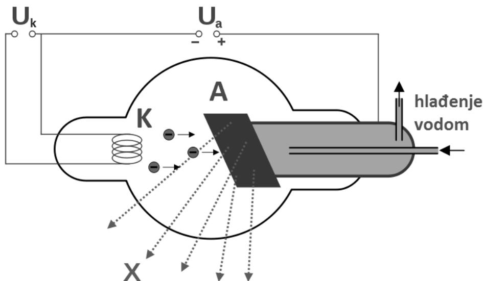
Slika 1.5. Shematski prikaz rendgenske cijevi hlađene vodom [148].  $U_k$  – napon žarenja katode;  $U_a$  – anodni napon; K – katoda; A – anoda; X – rendgensko zračenje. [148], prilagođeno.
