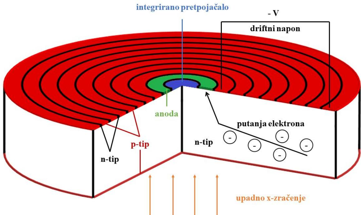
Slika 1.3. Shematski prikaz SDD detektora s integriranim prepojačalom. Autorica: M. Čargonja.
