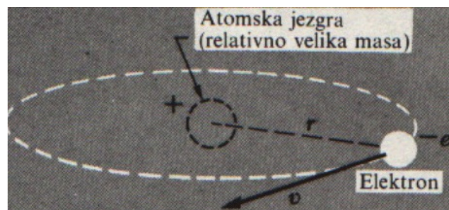
Slika 7.1: Model atoma u kojem se elektron gibao brzinom v po kružnoj putanji [8].
