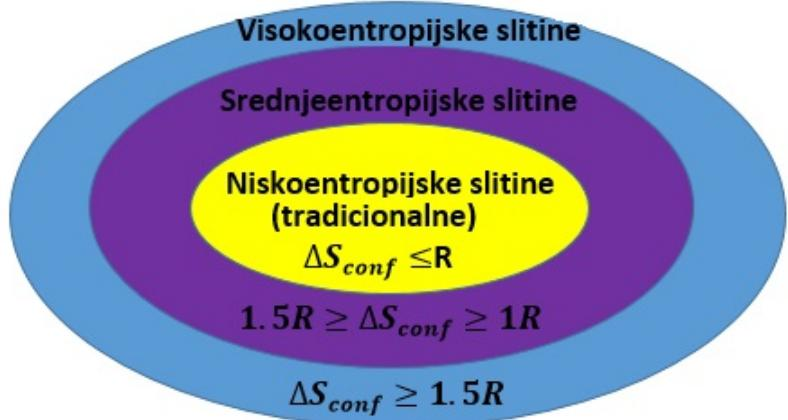
Slika 3.2: Shematski prikaz podjele slitina s obzirom na konfiguracijsku entropiju [5].
