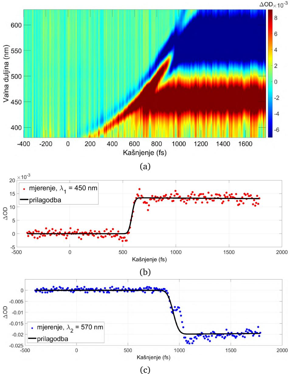
Slika 8.5: Tranzijentna apsorpcija rodamina B, pumpni puls je komprimiran u kompresoru sa SF10 prizmama koje su razmaknute  $L = 15$  cm. (a) Tranzijentna apsorpcija. Promjena optičke gustoće za (b) valnu duljinu  $\lambda_1 = 450$  nm i (c) valnu duljinu  $\lambda_2 = 570$  nm te prilagodba konvolucije. Dobivene vremenske rezolucije su:  $\Delta t_1 = 55$  fs i  $\Delta t_2 = 104$  fs.
