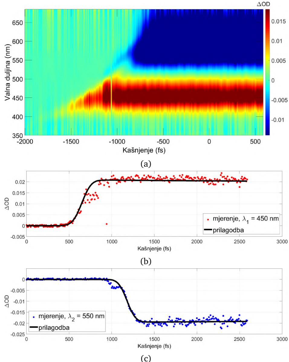
Slika 8.6: Tranzijentna apsorpcija rodamina B, pumpni puls je komprimiran u kompresoru s kvarcnim prizmama koje su razmaknute  $L = 61 \text{ cm}$ . (a) Tranzijentna apsorpcija. Promjena optičke gustoće za (b) valnu duljinu  $\lambda_1 = 450 \text{ nm}$  i (c) valnu duljinu  $\lambda_2 = 550 \text{ nm}$  te prilagodba konvolucije. Dobivene vremenske rezolucije su:  $\Delta t_1 = 188 \text{ fs}$ ,  $\Delta t_2 = 177 \text{ fs}$ .
