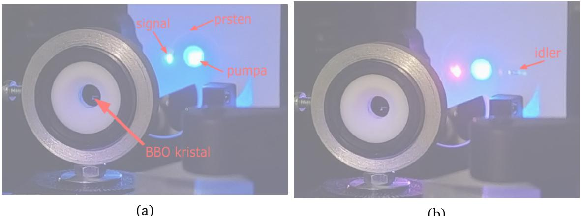
Slika 5.5: Fotografije  $\text{BBO}_{(\text{NOPA})}$  kristala i izlaznih zraka za dvije različite valne duljine izlaznog signala. Pod (a) se može primijetiti superfluorescentni prsten i nešto slabiji signal nego pod (b). Za valnu duljinu signala pod (b) kutevi ulaznih zraka i kut kristala točnije ispunjavaju uvjet faznog usklađivanja što se može vidjeti po jačem signalu, iščezavanju superfluorescentnog prstena i prisutnosti idlera.
