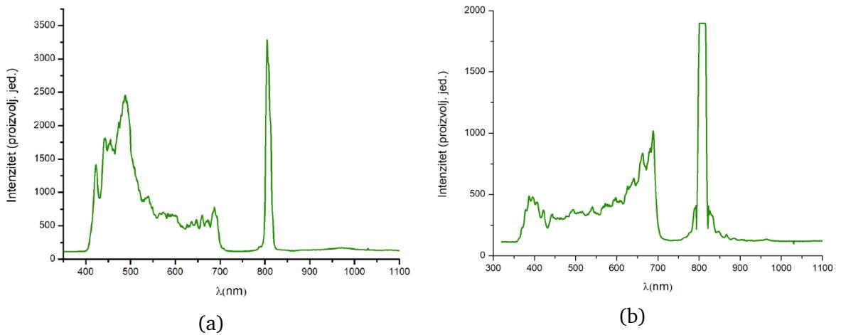
Slika 4.1: Spektar superkontinuuma nastao propagacijom pulsa trajanja 100 fs i valne duljine 800 nm kroz: (a) safirnu pločicu debljine 3 mm, (b) pločicu kalcijevog fluorida debljine 3 mm. Spektri su djelomično odrezani u blizini valne duljine ulazne zrake na 800 nm zbog korištenja apsorpcijskog filtera kako bi se izbjegla saturacija detektora ulaznim zračenjem puno većeg intenziteta. Preuzeto iz [9].
