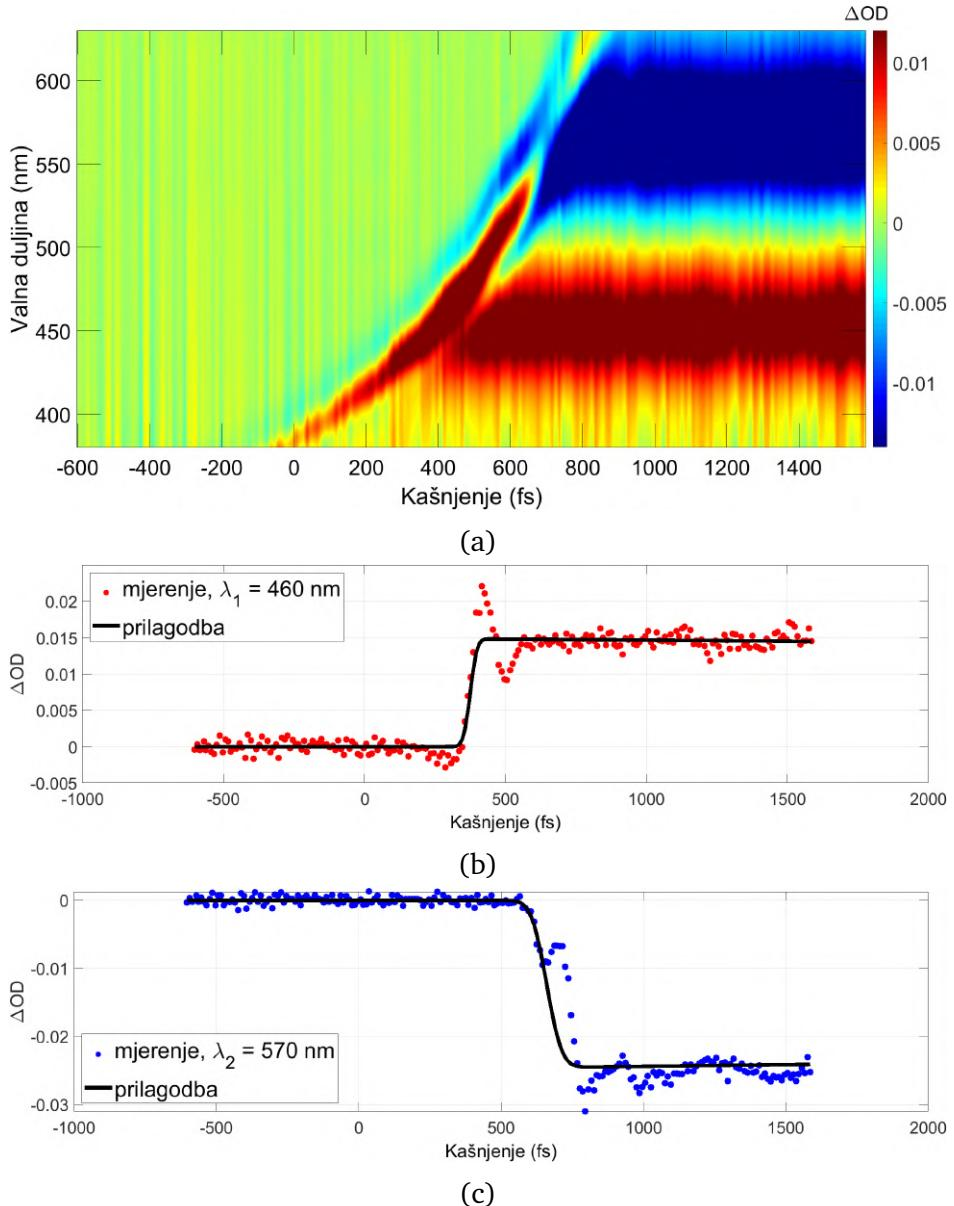
Slika D.2: Tranzijentna apsorpcija rodamina B, pumpni puls je komprimiran u kompresoru sa SF10 prizmama koje su razmaknute  $L = 14.1$  cm. (a) Tranzijentna apsorpcija. Promjena optičke gustoće za (b) valnu duljinu  $\lambda_1 = 460$  nm i (c) valnu duljinu  $\lambda_2 = 570$  nm te prilagodba konvolucije. Dobivene vremenske rezolucije su:  $\Delta t_1 = 45$  fs i  $\Delta t_2 = 99$  fs.
