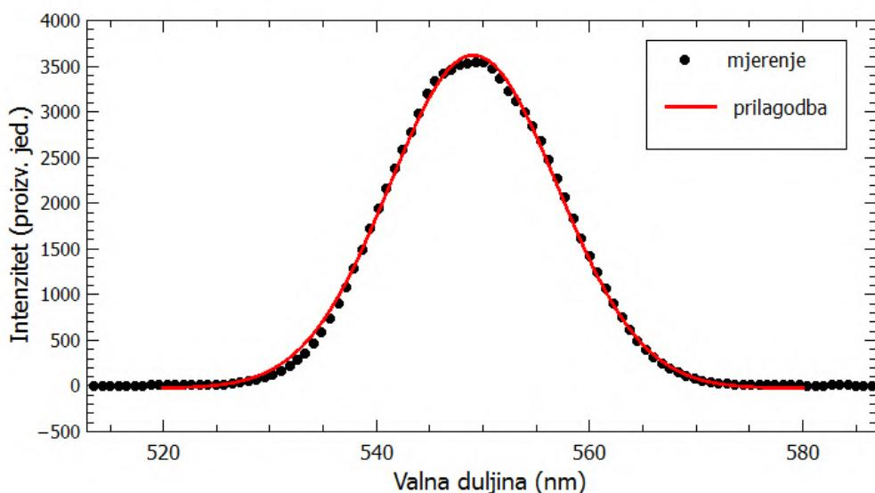
Slika 8.8: Spektar izlaznog signala iz nekolinearnog optičkog parametarskog pojačala bez kompresora te prilagodba Gaussove funkcije. Iz prilagodbe dobivene su vrijednosti centralne valne duljine  $\lambda = 549 \text{ nm}$  i spektralne širine  $\Delta\lambda = 18.6 \text{ nm}$ .
