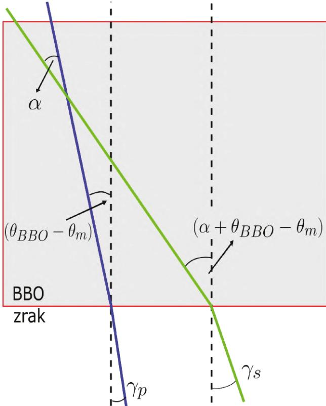
Slika 5.3: Geometrija upadnih zraka na BBO nelinearni kristal. Kutevi  $\alpha$  i  $\theta_m$  odgovaraju kutevima faznog usklađivanja,  $\theta_{BBO}$  je kut pod kojim je odrezan kristal, a  $\gamma_p$  i  $\gamma_s$  su upadni kutevi pumpe i signala.
