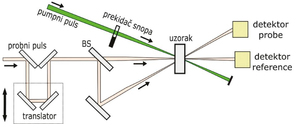
Slika 6.1: Shematski prikaz eksperimentalnog postava tranzijentne apsorpcije.
