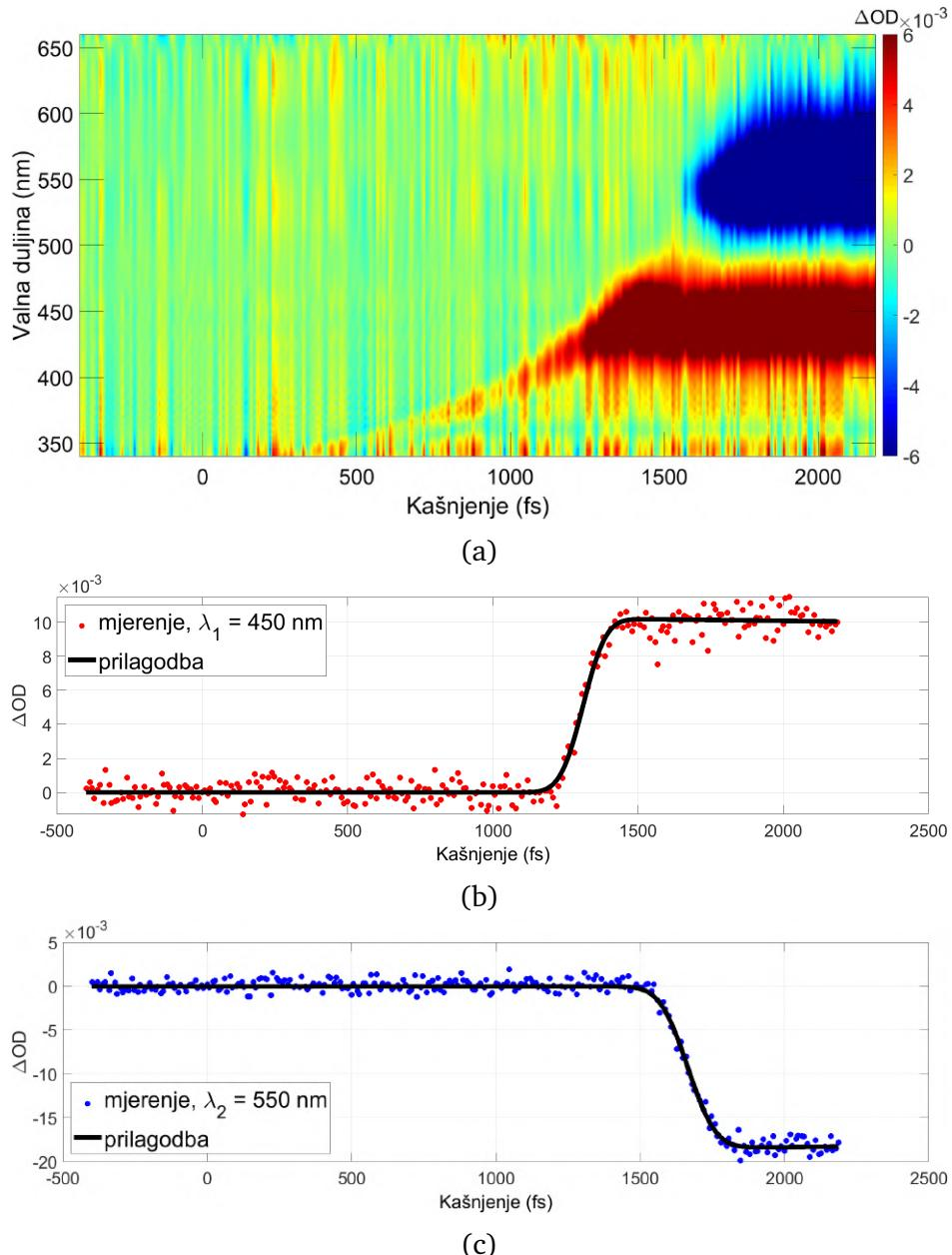
Slika 8.2: Tranzijentna apsorpcija rodamina B bez korištenja kompresora za pumpni puls. (a) Tranzijentna apsorpcija. Promjena optičke gustoće za (b) valnu duljinu  $\lambda_1 = 450$  nm i (c) valnu duljinu  $\lambda_2 = 550$  nm te prilagodba konvolucije. Dobivene vremenske rezolucije su:  $\Delta t_1 = 145$  fs,  $\Delta t_2 = 179$  fs.
