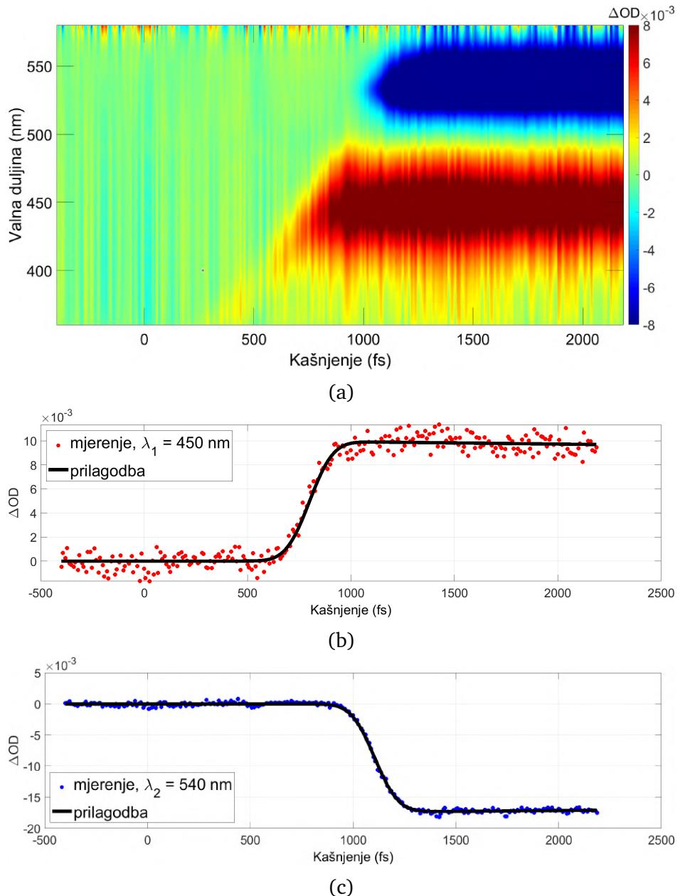
Slika D.1: Tranzijentna apsorpcija rodamina B, pumpni puls je komprimiran u kompresoru sa SF10 prizmama koje su razmagnute  $L = 12$  cm. (a) Tranzijentna apsorpcija. Promjena optičke gustoće za (b) valnu duljinu  $\lambda_1 = 460$  nm i (c) valnu duljinu  $\lambda_2 = 540$  nm te prilagodba konvolucije. Dobivene vremenske rezolucije su:  $\Delta t_1 = 212$  fs i  $\Delta t_2 = 212$  fs.
