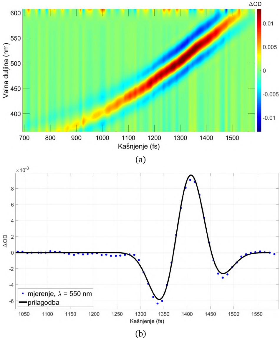
Slika 8.4: Mjerenje međufazne modulacije u metanolu, pumpni puls je komprimiran u kompresoru sa SF10 prizmama koje su razmaknute  $L = 15 \text{ cm}$ . (a) Tranzijentna apsorpcija, (b) promjena optičke gustoće za valnu duljinu  $\lambda = 550 \text{ nm}$  te prilagodba međufazne modulacije. Dobiveno trajanje pumpnog pulsa iznosi 132 fs.
