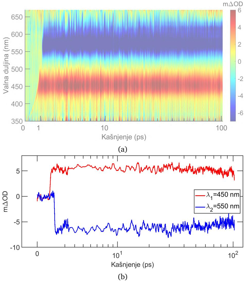
Slika 8.1: Tranzijentna apsorpcija rodamina B bez korištenja kompresora za pumpni puls. (a) Tranzijentna apsorpcija. (b) Promjena optičke gustoće za valne duljine  $\lambda_1 = 450$  nm i  $\lambda_2 = 550$  nm. Vremenska skala predstavljena je u logaritamskom mjerilu kako bi početna dinamika bila uočljivija
