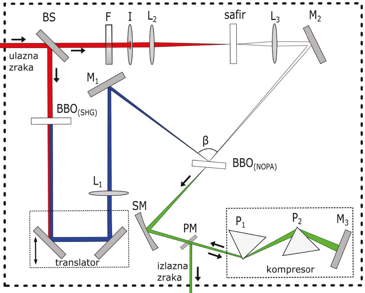
Slika 5.4: Shematski prikaz nekolinearnog optičkog parametarskog pojačala.
