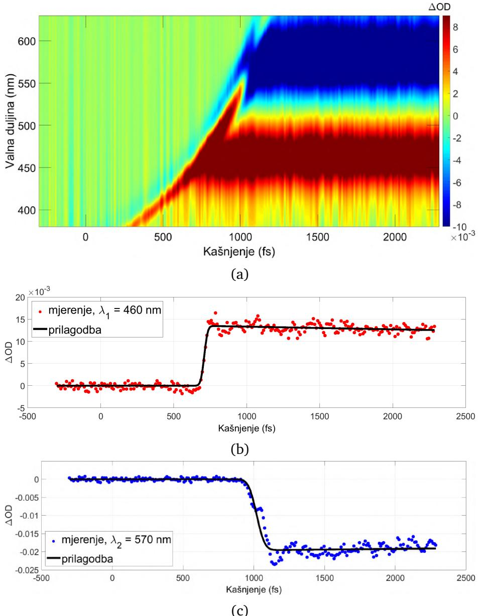
Slika 8.3: Tranzijentna apsorpcija rodamina B, pumpni puls je komprimiran u kompresoru sa SF10 prizmama koje su razmaknute  $L = 13.4$  cm. (a) Tranzijentna apsorpcija. Promjena optičke gustoće za (b) valnu duljinu  $\lambda_1 = 460$  nm i (c) valnu duljinu  $\lambda_2 = 570$  nm te prilagodba konvolucije. Dobivene vremenske rezolucije su:  $\Delta t_1 = 45$  fs i  $\Delta t_2 = 106$  fs.
