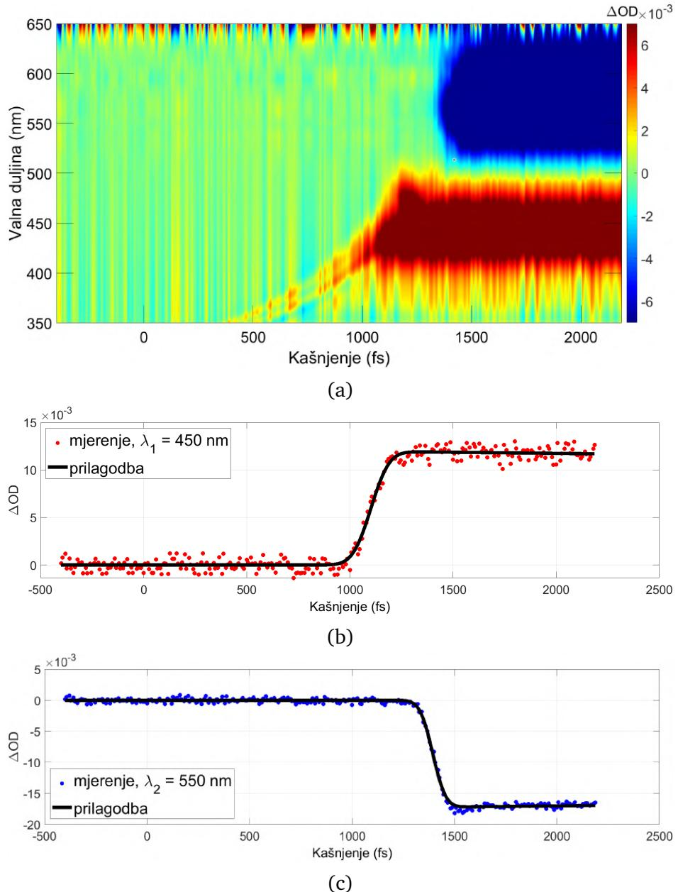
Slika D.3: Tranzijentna apsorpcija rodamina B, pumpni puls je komprimiran u kompresoru s kvarcnim prizmama koje su razmaknute  $L = 36.8$  cm. (a) Tranzijentna apsorpcija. Promjena optičke gustoće za (b) valnu duljinu  $\lambda_1 = 450$  nm i (c) valnu duljinu  $\lambda_2 = 550$  nm te prilagodba konvolucije. Dobivene vremenske rezolucije su:  $\Delta t_1 = 163$  fs i  $\Delta t_2 = 117$  fs.
