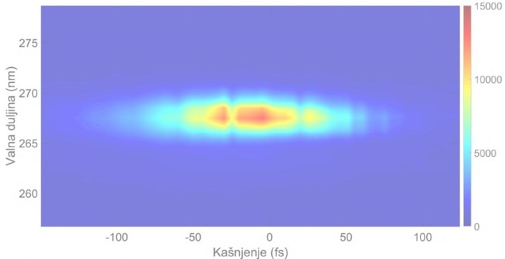
Slika 8.9: FROG spektrogram izlaznog signala iz nekolinearnog optičkog parametarskog pojačala. Dobiveno vrijeme trajanja pulsa iznosi 88 fs, a spektralna širina iznosi 8.15 nm.
