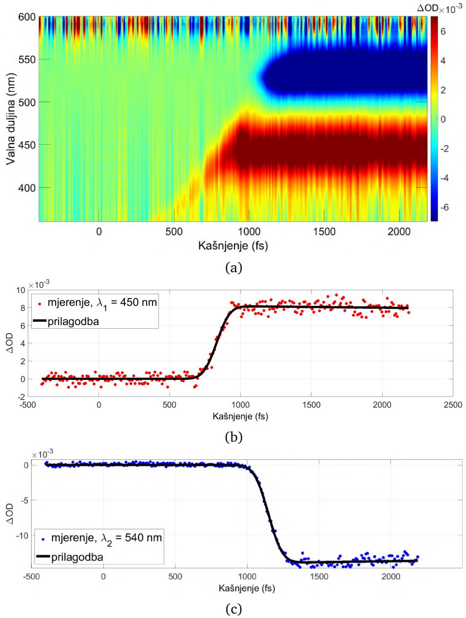
Slika D.4: Tranzijentna apsorpcija rodamina B, pumpni puls je komprimiran u kompresoru s kvarcnim prizmama koje su razmaknute  $L = 49.5$  cm. (a) Tranzijentna apsorpcija. Promjena optičke gustoće za (b) valnu duljinu  $\lambda_1 = 450$  nm i (c) valnu duljinu  $\lambda_2 = 540$  nm te prilagodba konvolucije. Dobivene vremenske rezolucije su:  $\Delta t_1 = 174$  fs,  $\Delta t_2 = 183$  fs.
