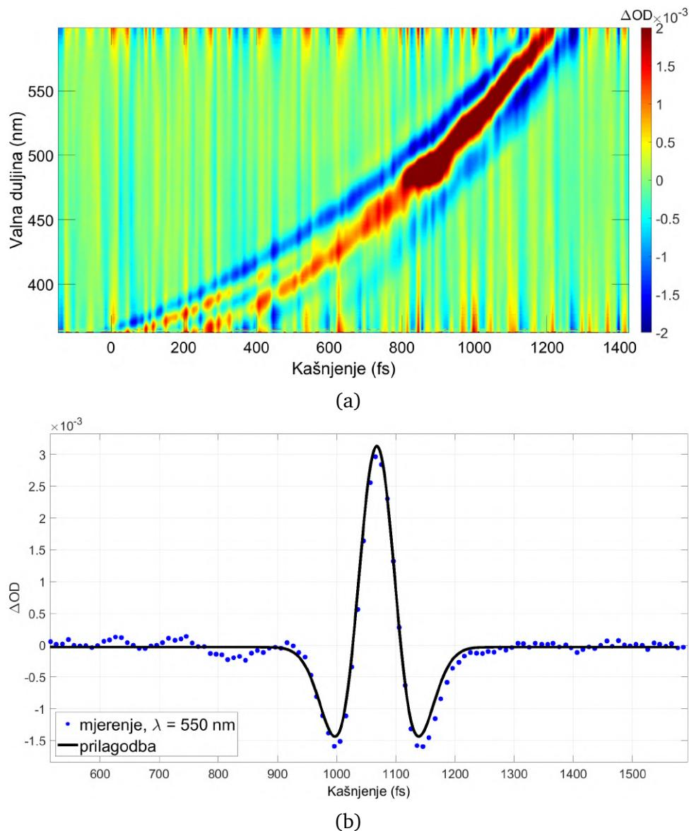
Slika 8.7: Mjerenje međufazne modulacije u metanolu, pumpni puls je komprimiran u kompresoru s kvarcnim prizmama koje su razmagnute  $L = 61$  cm. (a) Tranzijentna apsorpcija, (b) promjena optičke gustoće za valnu duljinu  $\lambda = 550$  nm te prilagodba međufazne modulacije. Dobiveno trajanje pumpnog pulsa iznosi 137 fs.
