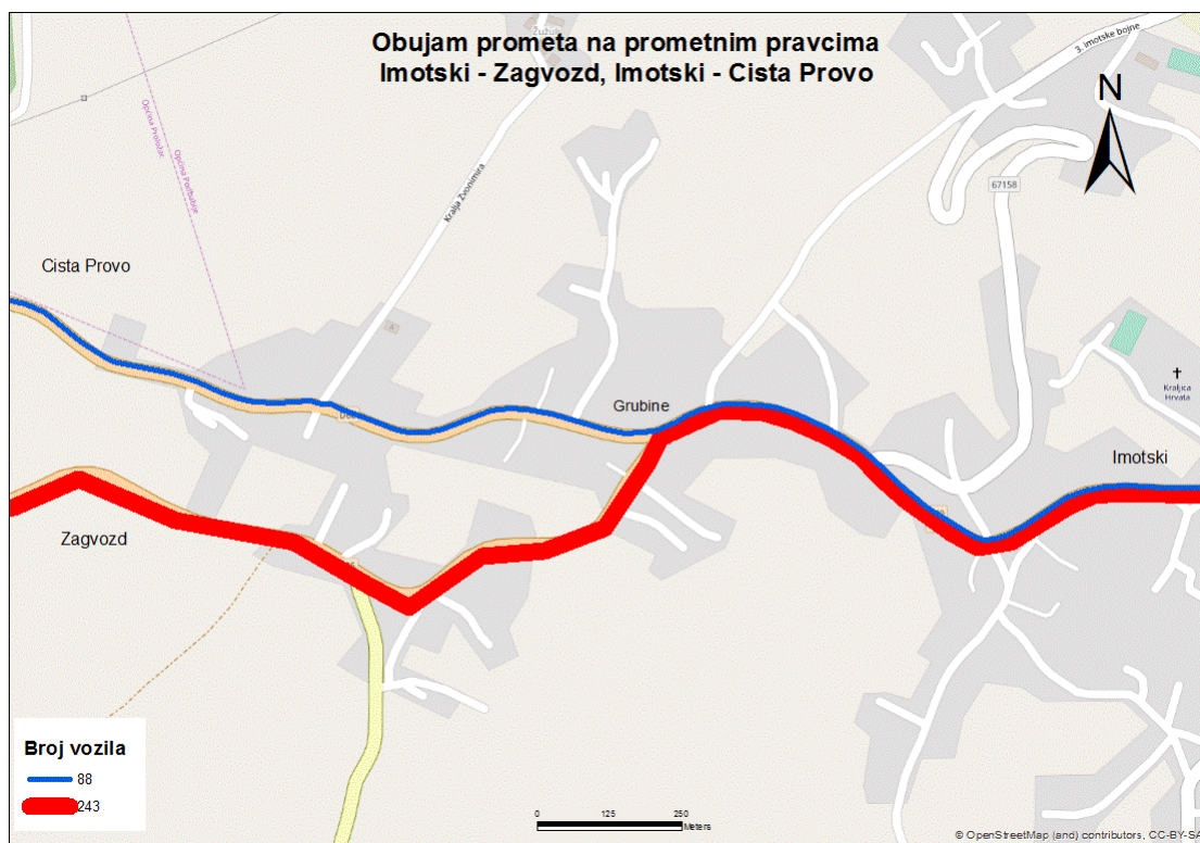
Sl. 15. Obujam prometa na odabranim pravcima prijepodne – nedjelja Izvor: Vlastita izrada prema ručnom terenskom brojanju prometa
