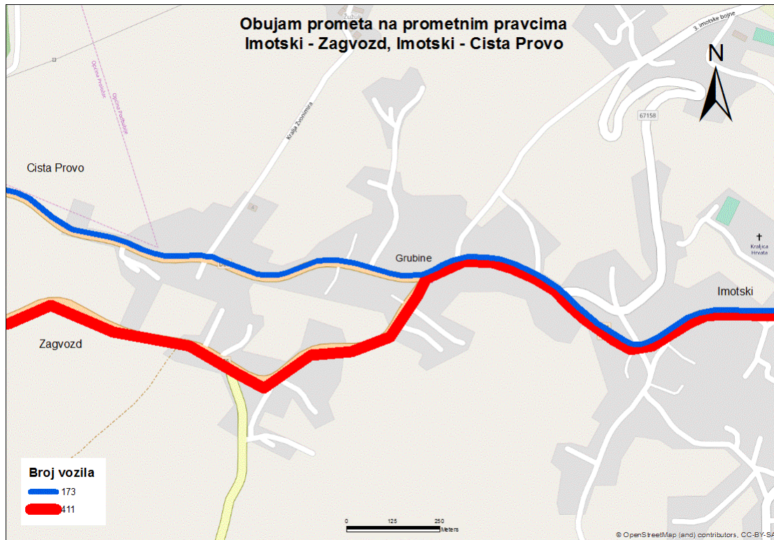
Sl. 16. Obujam prometa na odabranim pravcima poslijepodne – nedjelja Izvor: Vlastita izrada prema ručnom terenskom brojanju prometa
