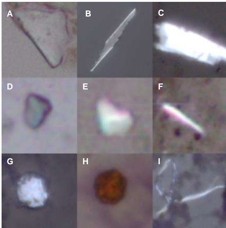
Slika 6. Reprezentativni primjeri mikroplastike pronađeni u uzorcima dagnji Mytilus galloprovincialis na postajama u sjevernom Jadranu snimljenim svjetlosnim mikroskopom pomoću polarizatora. A), B) i C) film; D) i E) pelet; F) filament (Avio i
