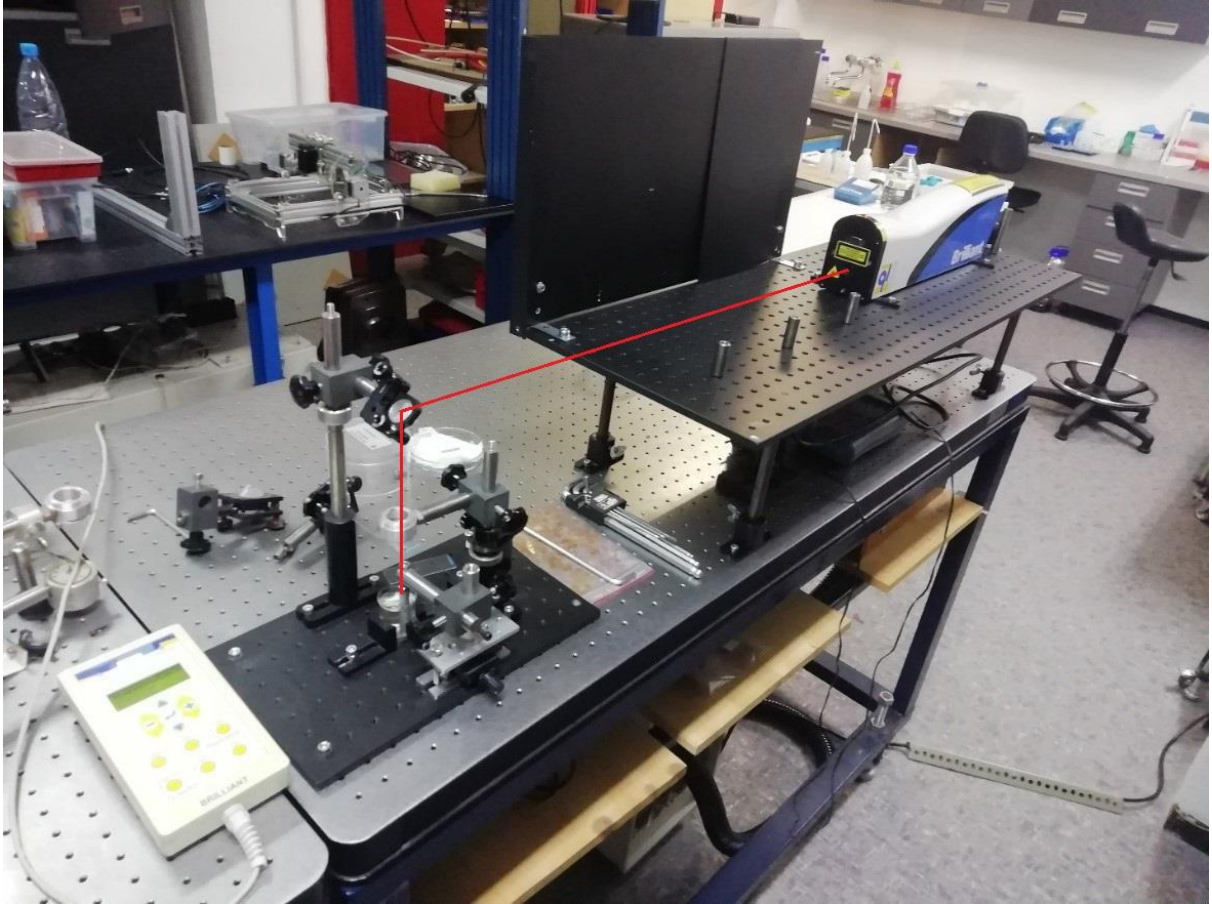
Slika 4 Eksperimentalni postav laserske ablacije u tekućini
