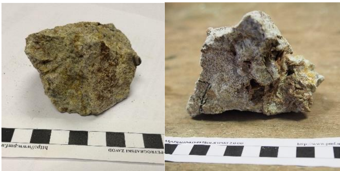
Slika 25. Lijevo: izgled uzorka VS19 i žila siderita, pirita i kvarca, desno: žile siderita, pirita i kvarca na svježem presjeku
