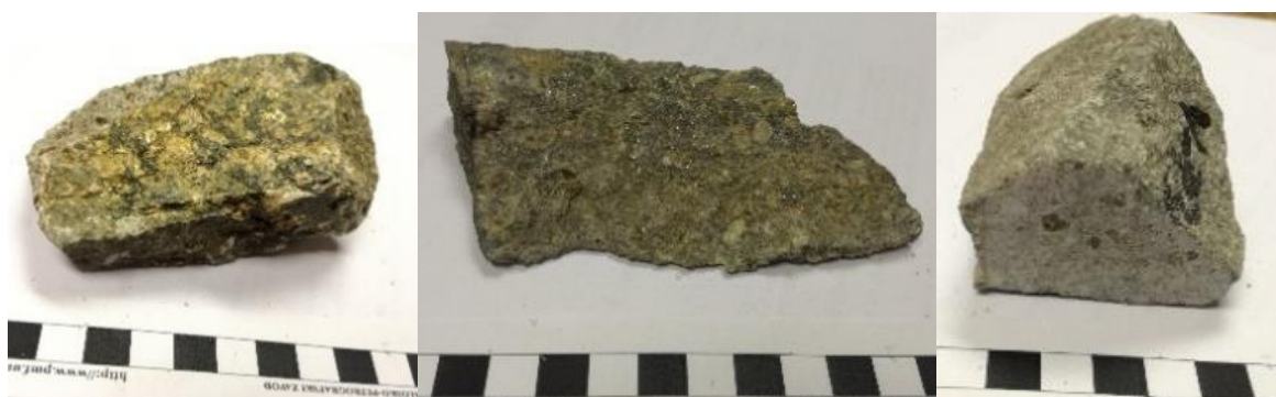
Slika 18. Lijevo: uzorak VS7 sa žilom karbonata, klorita i pirita, sredina: uzorak VS7 sa žilom pirita i speksularita, desno: uzorak VS7 i njegov izgled na svježem presjeku
