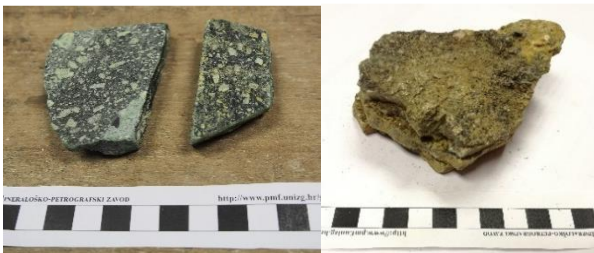
Slika 20. Uzorak VS9: lijevo: izgled uzorka na svježem presjeku, desno: set paralelnih žila pirita i kvarca
