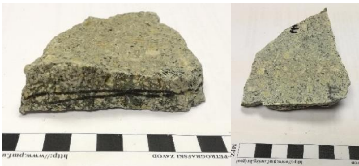
Slika 17. Lijevo: žila klorita i speksularita na uzorku VS6, desno: izgled presjeka uzorka VS6 sa šeste točke uzorkovanja
