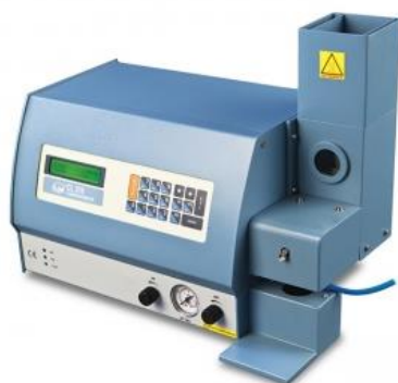
Slika 1. Prikaz instrumenta za plamenu emisijsku spektroskopiju
