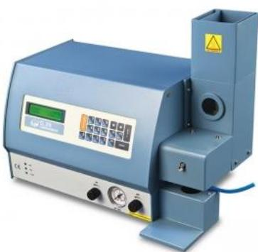
Slika 1. Prikaz instrumenta za plamenu emisijsku spektroskopiju
