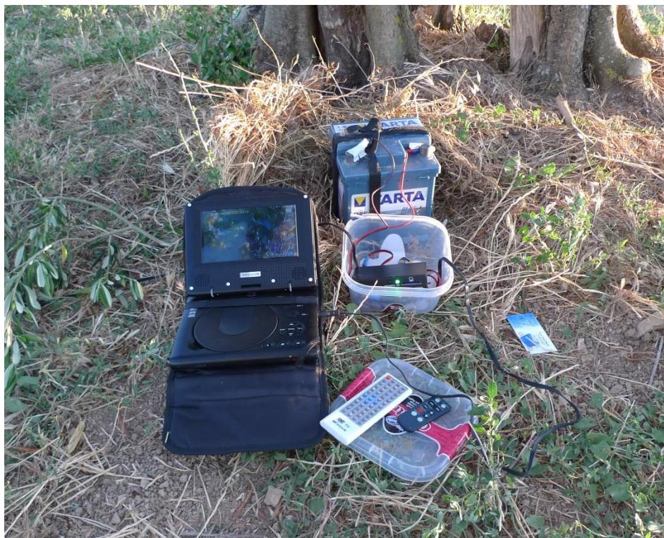
**Slika 7.** SD snimač u vodootpornoj kutiji spojen s akumulatorom i prijenosnim DVD reproduktorm.
