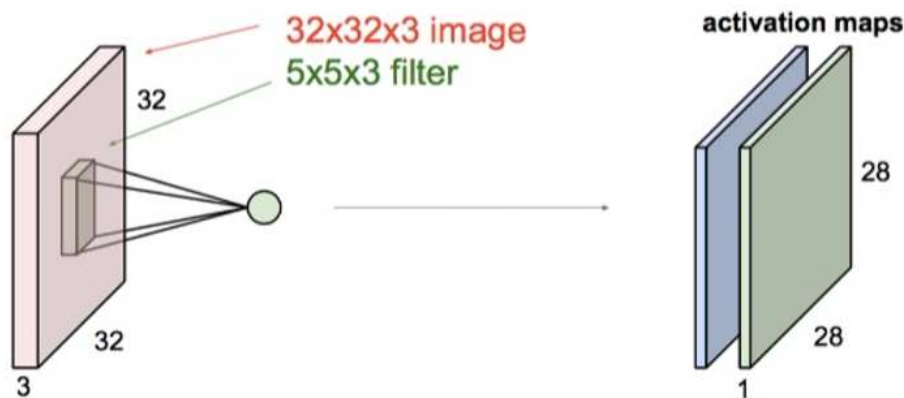
Slika 3.20: Primjer konvolucijskog sloja
