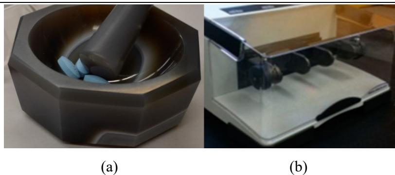
Slika 17. Tarionik s tučkom (a) i vibracijski mlin (b)<sup>37</sup>
