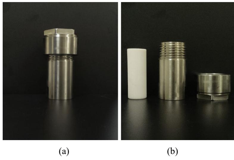
Slika 16. Prikaz zatvorenog autoklava (a) i dijelova autoklava (b)<sup>32</sup>
