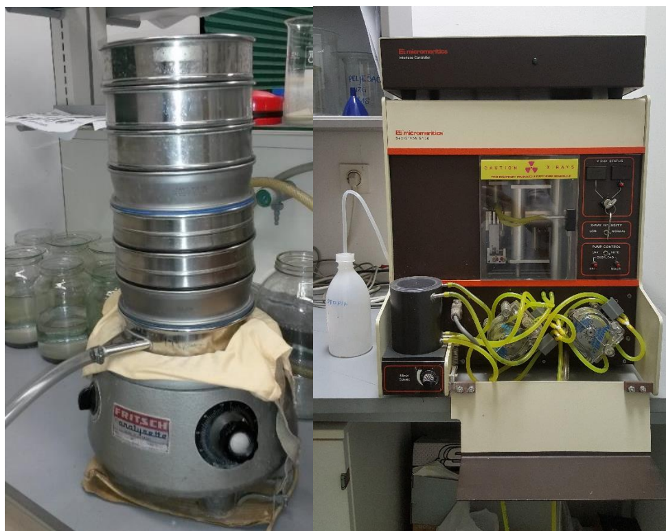
Slika 8. (a) Mokro sijanje uz pomoć tresilice i (b) sedigraf za analizu veličine zrna.
