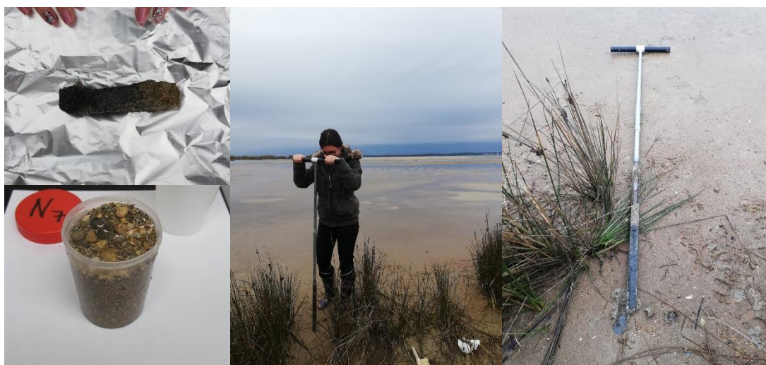
Slika 6. (a) Zamatanje sedimentne jezgre, uzorak za mikropaleontološku analizu, (b) pohranjeni uzorak za granulometrijsku analizu, (c) uzorkovanje metodom plitkog jezgrovanja (Fotografija: K. Križnjak), (d) pogled na izvađenu jezgru sedimenta.
