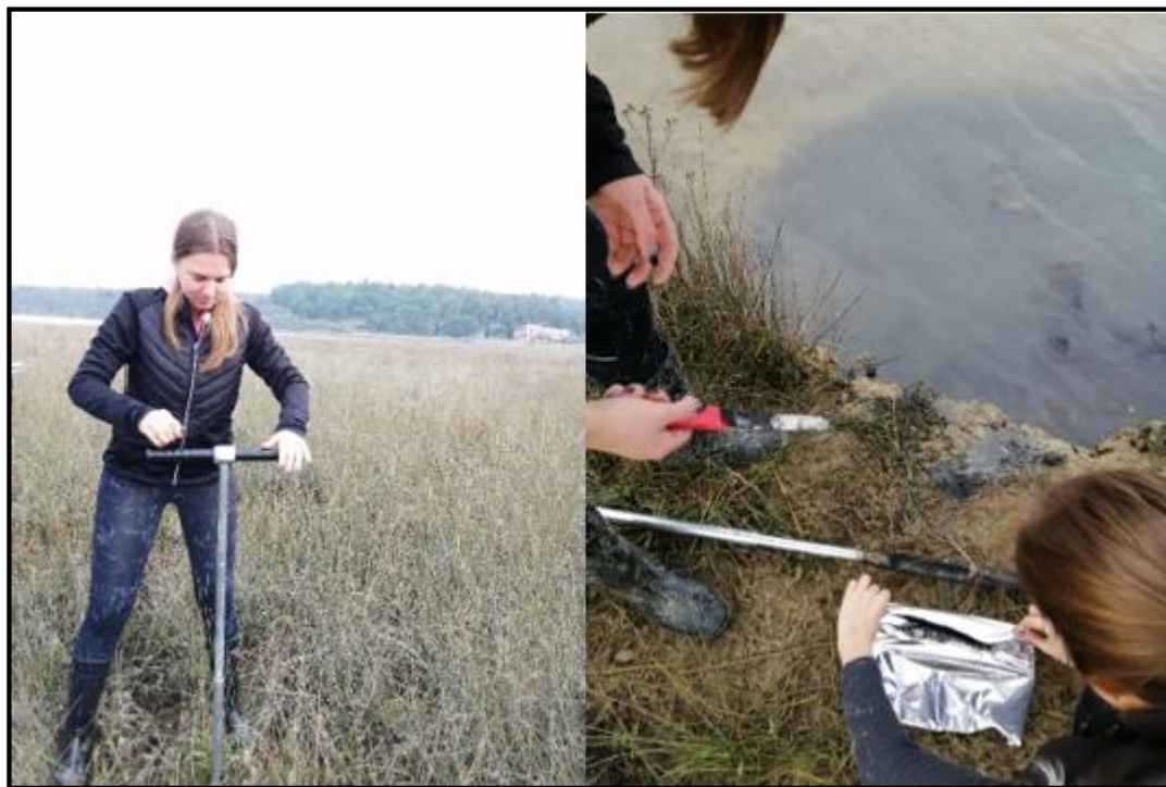
Slika 4. Uzorkovanje jezgrilom (lijevo), vađenje uzorka iz jezgrila i pravilno spremanje (desno)(M.Čančar)
