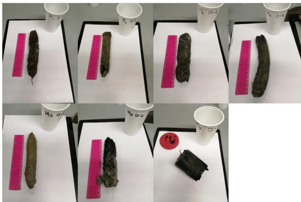
Slika 6. Mjerenje uzorkovanih jezgara i podjela na intervale od 2 cm
