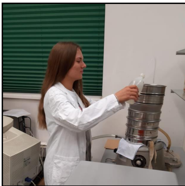
Slika 8. Mokro sijanje na standardnim Retsch® ASTM sitima u laboratoriju Geološko-paleontološkog zavoda (I. Felja)
