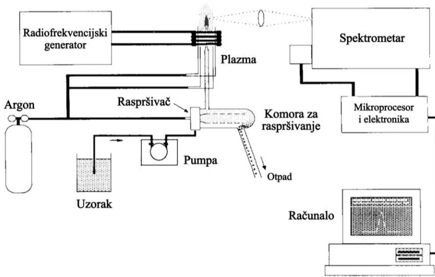
Slika 5. Dijelovi ICP-AES instrumenta (ilustracija preuzeta i prilagođena prema literarnom izvoru).<sup>51</sup>
