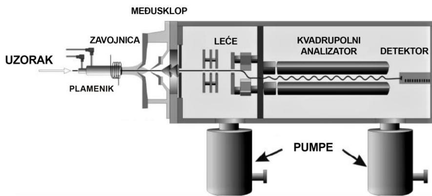
Slika 6. Shematski prikaz dijelova ICP-MS instrumenta (ilustracija preuzeta i prilagođena prema literaturnom izvoru).<sup>54</sup>
