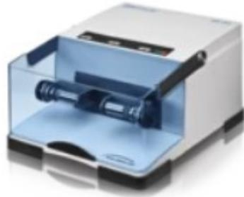
Slika 11. Laboratorijski vibracijski mikromlin.<sup>22</sup>
