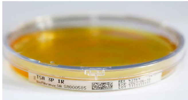
Slika 7. Prikaz TSA3 (engl. TrypCase Soy 3P agar ) mikrobiološke ploče (90 mm) za provjeru sterilnosti čistih prostora
