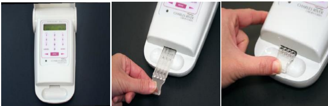
Slika 6. Prikaz određivanja endotoksina pomoću uređaja PTS.
