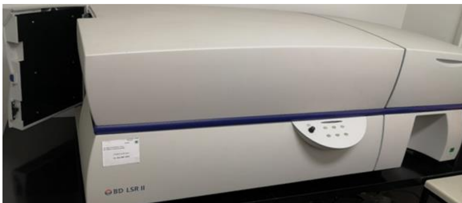
Slika 4. Protočni citrometar BD LRS II korišten za provjeru postotka ostatnih 3T3 stanica.
