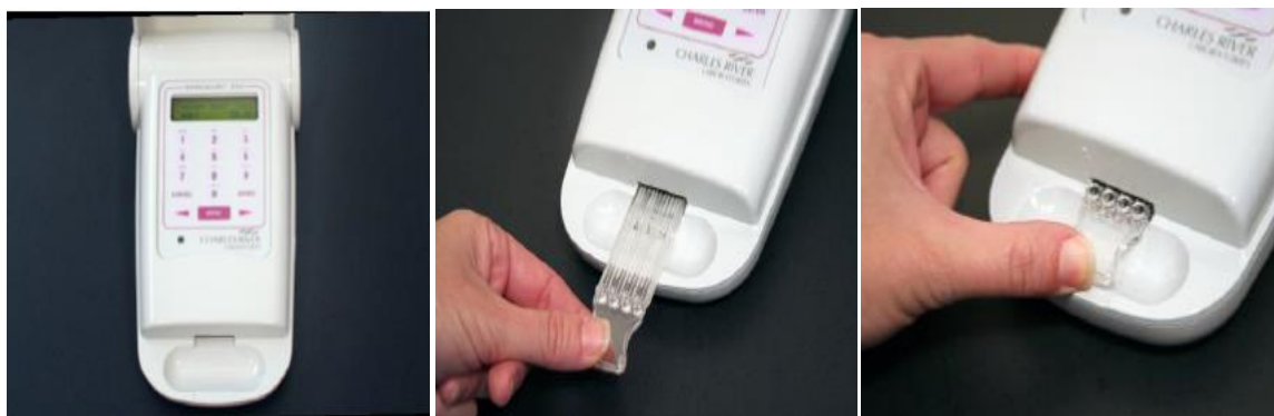
Slika 6. Prikaz određivanja endotoksina pomoću uređaja PTS.
