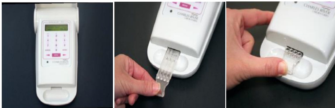
Slika 6. Prikaz određivanja endotoksina pomoću uređaja PTS.
