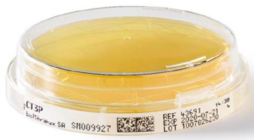
Slika 8. Prikaz CT3P (engl. Count-Tact 3P agar ) mikrobiološke ploče (55 mm) za provjeru sterilnosti kontaktnih površina
