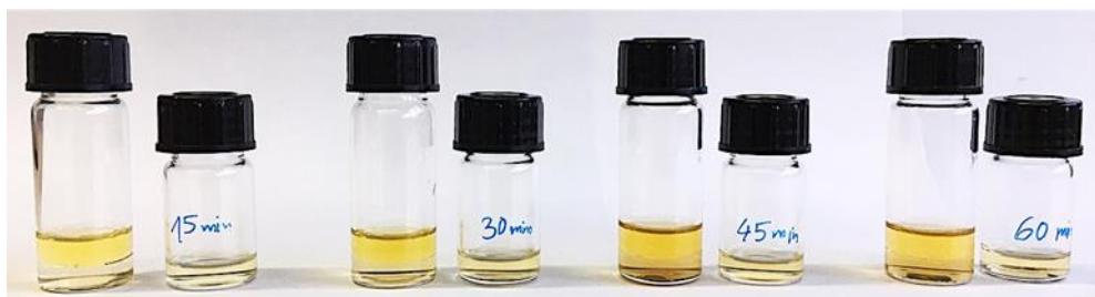
Slika 19. Viale s obrađenom reakcijskom smjesom za analizu plinskom kromatografijom nakon 15, 30, 45 i 60 minuta reakcije
