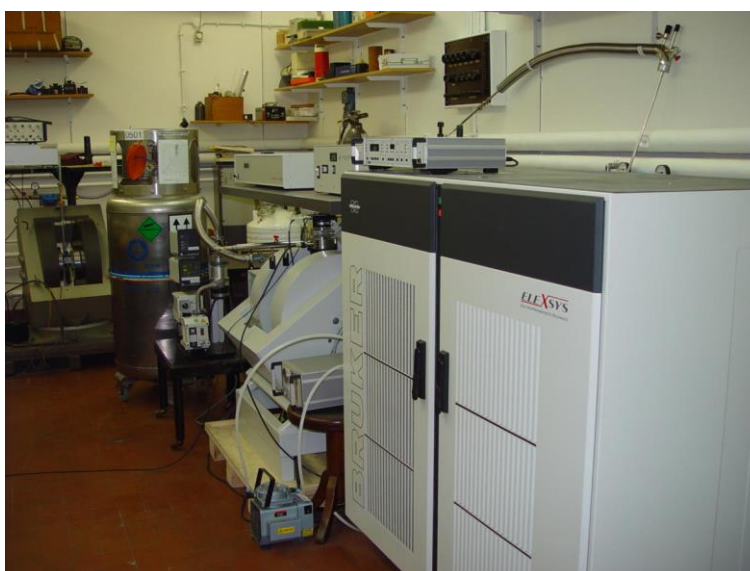
Slika 21. Bruker Elexsys 580 FT/CW EPR spektrometar (slika preuzeta s reference 75).
