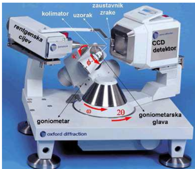
Slika 13. Osnovni dijelovi difraktometra Oxford Diffraction Xcalibur i definicija kutova goniometra i detektora (slika preuzeta s Upute za vježbu "Rentgenska strukturna analiza jediničnog kristala" u Višem praktikumu anorganske kemije na diplomskom studiju kemije (istraživački smjer) – samo za internu uporabu; autor: Dalibor Milić 2013. godina).
