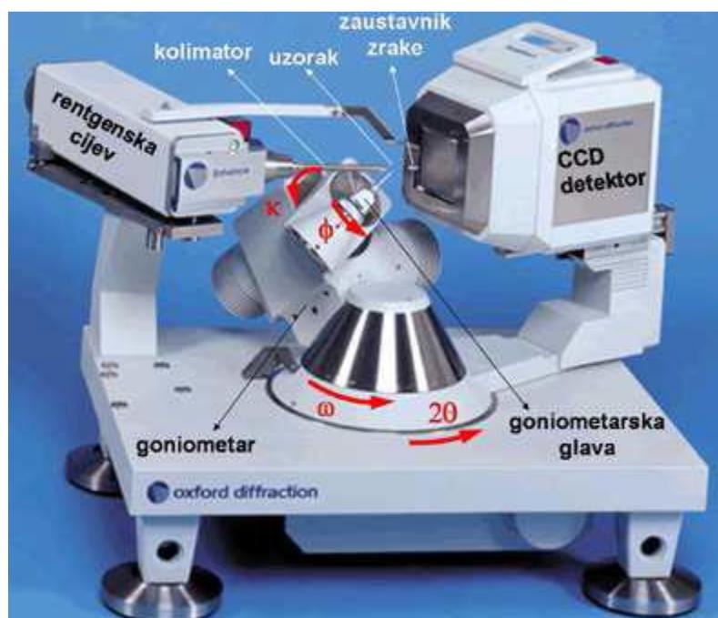
Slika 13. Osnovni dijelovi difraktometra Oxford Diffraction Xcalibur i definicija kuta goniometra i detektora (slika preuzeta s Upute za vježbu "Rentgenska strukturalna analiza jediničnog kristala" u Višem praktikumu anorganske kemije na diplomskom studiju kemije (istraživački smjer) – samo za internu uporabu; autor: Dalibor Milić 2013. godina).
