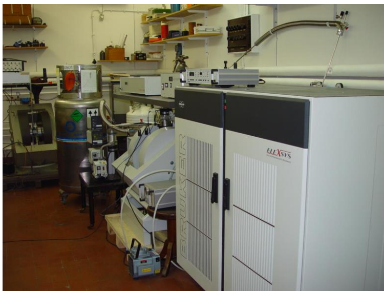
Slika 21. Bruker Elexsys 580 FT/CW EPR spektrometar (slika preuzeta s reference 75).
