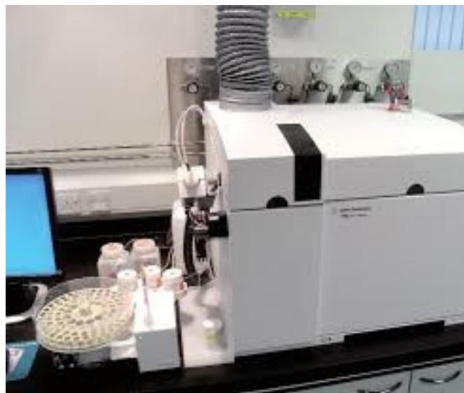
Slika 11. Spektometar *Agilent 7500cx ICP-MS*
