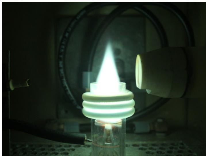
Slika 9. Induktivno spregnuta plazma<sup>51</sup>
