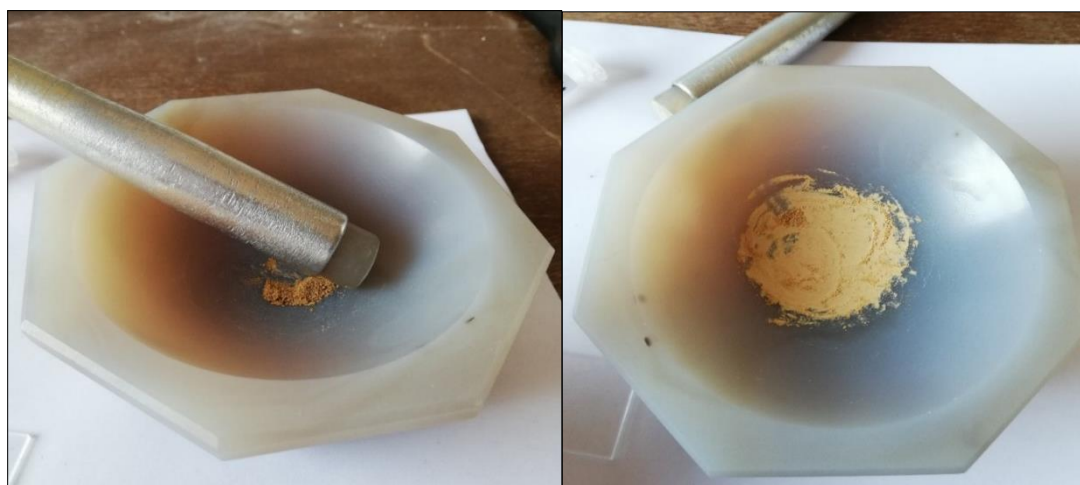
Slika 8. Usitnjavanje netopivih ostataka poduzoraka boksita u prah u ahatnom tarioniku
