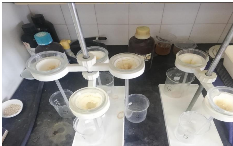
Slika 3. Sušenje filtriranog taloga zaostalog nakon otapanja uzoraka 1-6 iz seta 2 i seta 3
