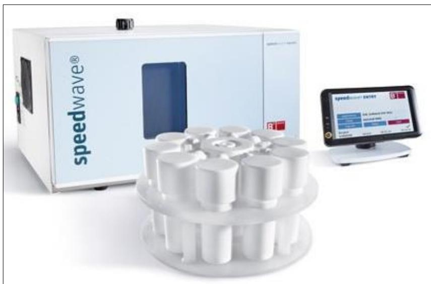
Slika 6. Mikrovalna peć za mikrovalnu digestiju (izvor:
