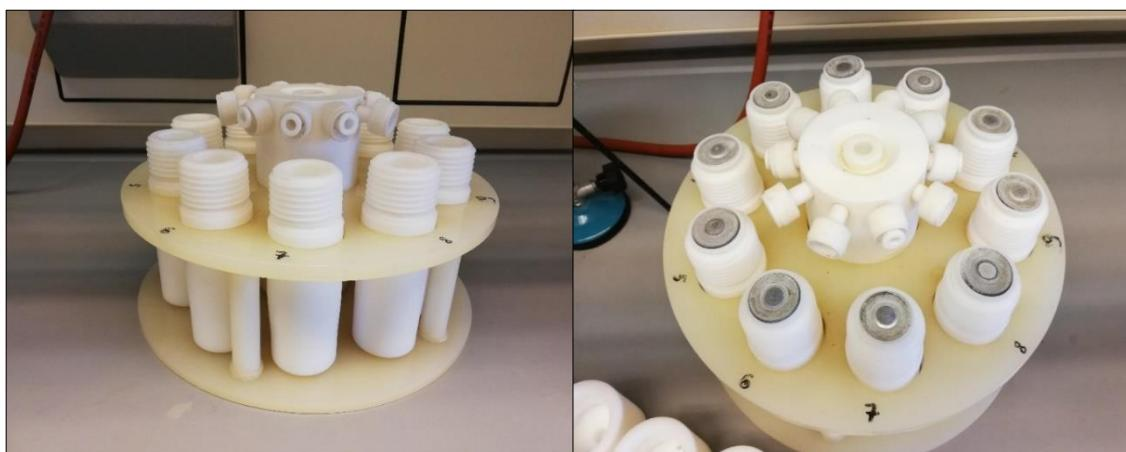
Slika 5. Teflonske posude s uzorcima boksita
