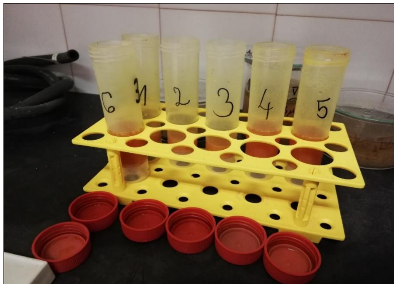
Slika 2. Prikaz uzoraka iz setova 2 i 3 otapanih zlatotopkom u kivetama 24 sata
