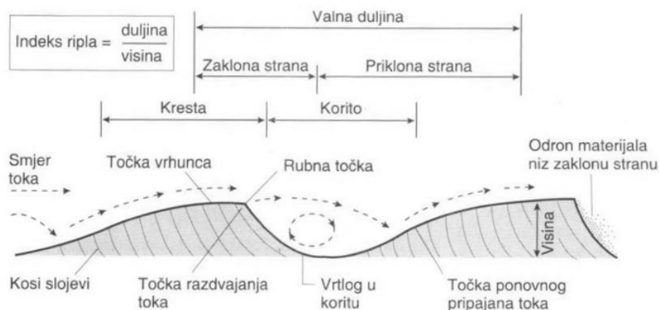
Slika 2: Prikaz nastanka asimetričnih riplova (Tucker, 2001)
