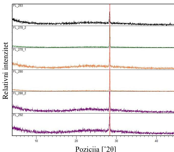
*Slika 43: Difraktogrami uzorka fluorita sa označenom referentnom linijom*
