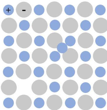
*Slika 7: Shematski prikaz Frenkelovog defekta*
