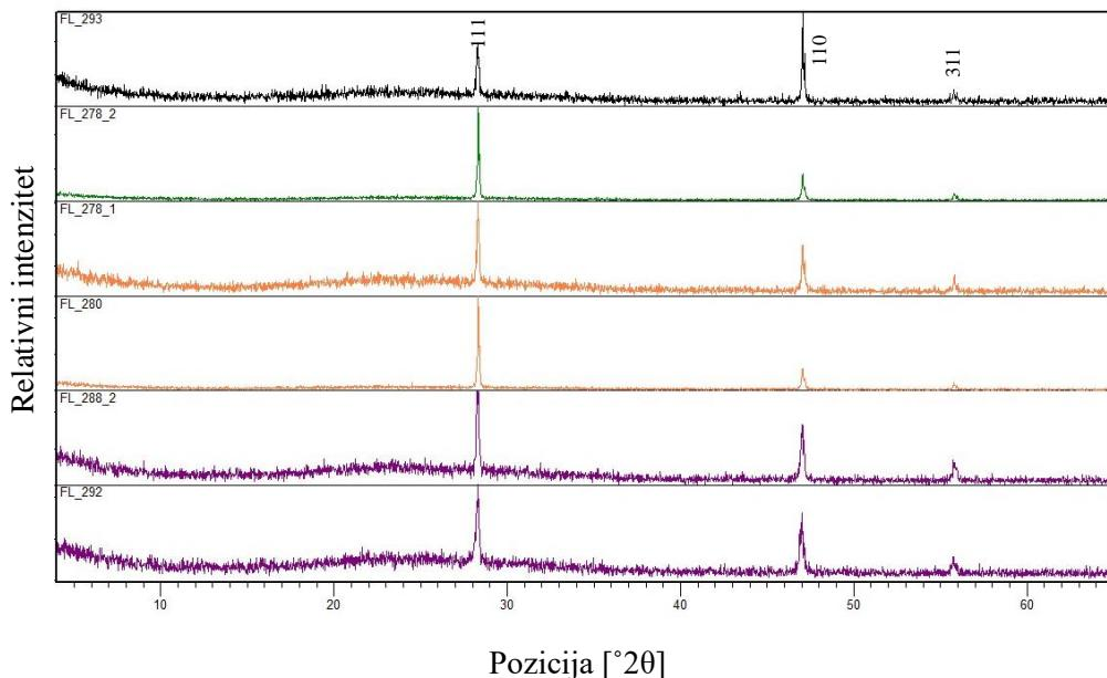
*Slika 25: Usporedba spektara uzoraka fluorita dobivenih XRD metodom*
