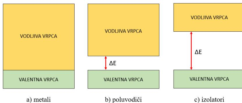
Slika 6: Shematski prikaz energetskih prijelaza kod metala (vodiča), poluvodiča i izolatora
