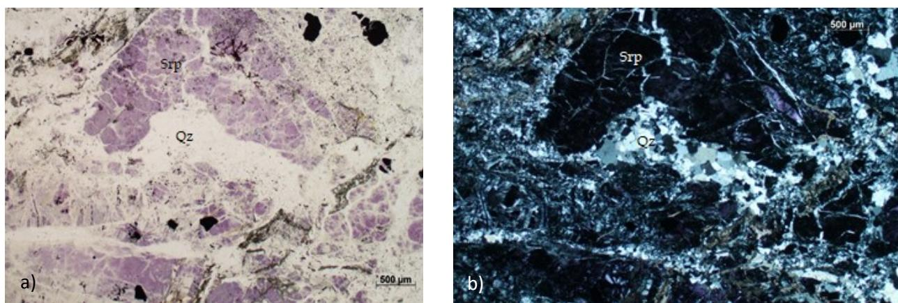
Slika 17. Mikroskopski uzorak Lojane 4 a) bez analizatora b) sa analizatorom (Kratice vidi sliku 8 i 11)
