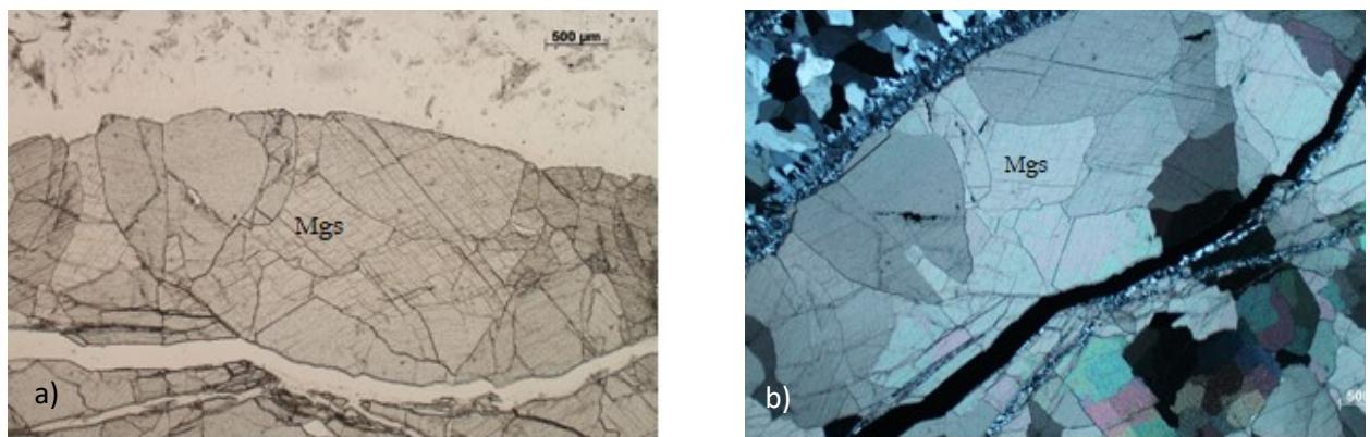
Slika 9. Mikroskopski uzorak Lojane 1 a) bez analizatora b) s analizatorom (za kratice vidjeti sliku 8)
