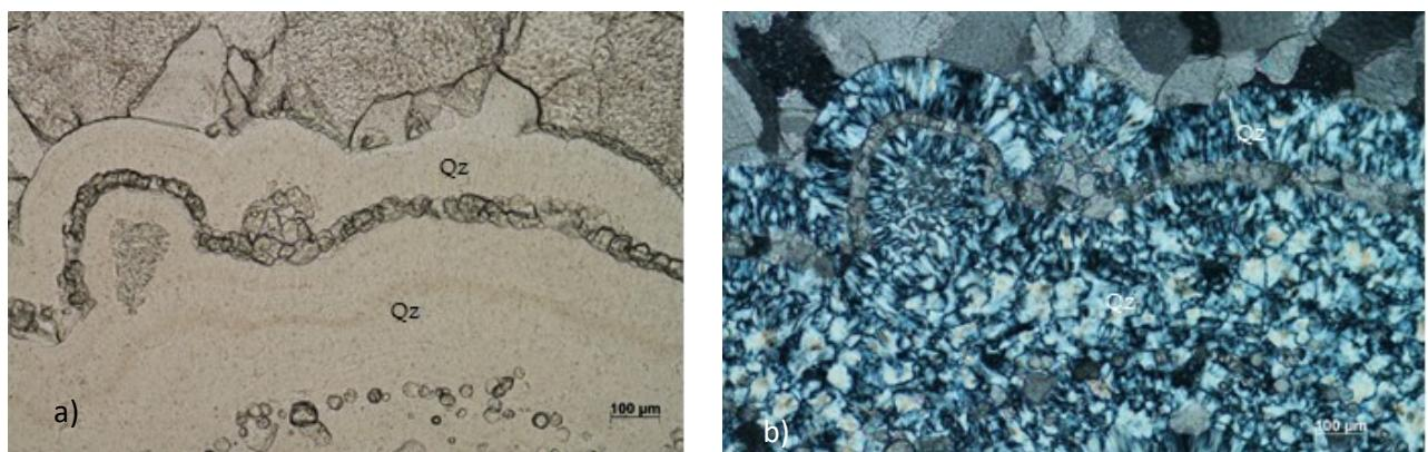
Slika 10. Mikroskopski uzorak Lojane 1 a) bez analizatora b) s analizatorom (za kratice vidjeti sliku 8); vidljiva krustifikacija
