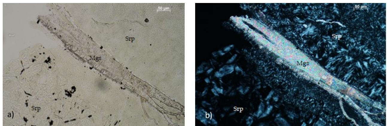
Slika 13. Mikroskopski uzorak Lojane 2 a) bez analizatora b) sa analizatorom (za kratice vidjeti slike 8 i 11)
