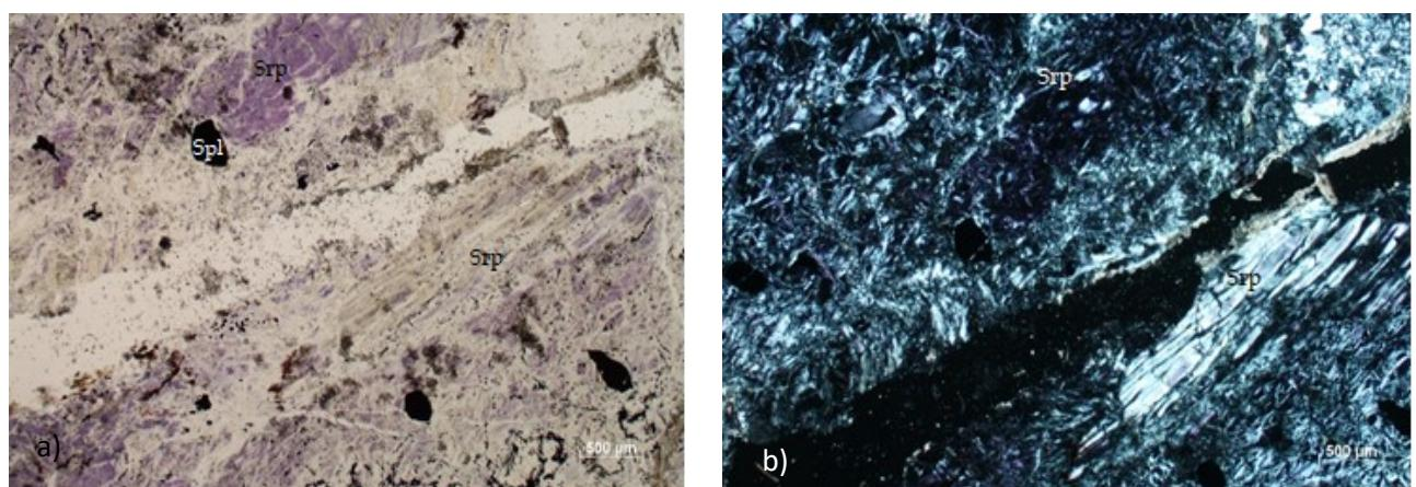
Slika 14. Mikroskopski uzorak Lojane 4 a) bez analizatora b) s analizatorom (za kratice vidjeti sliku 11)
