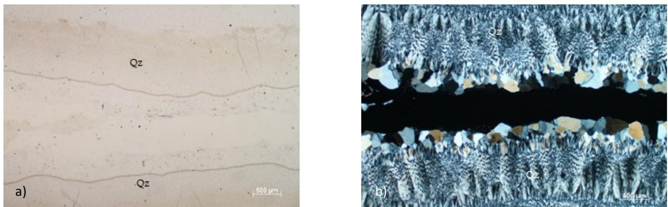
Slika 12. Mikroskopski uzorak Lojane 2 a) bez analizatora b) sa analizatorom ( za kratice vidjeti sliku 8) vidljiva simetrična tekstura
