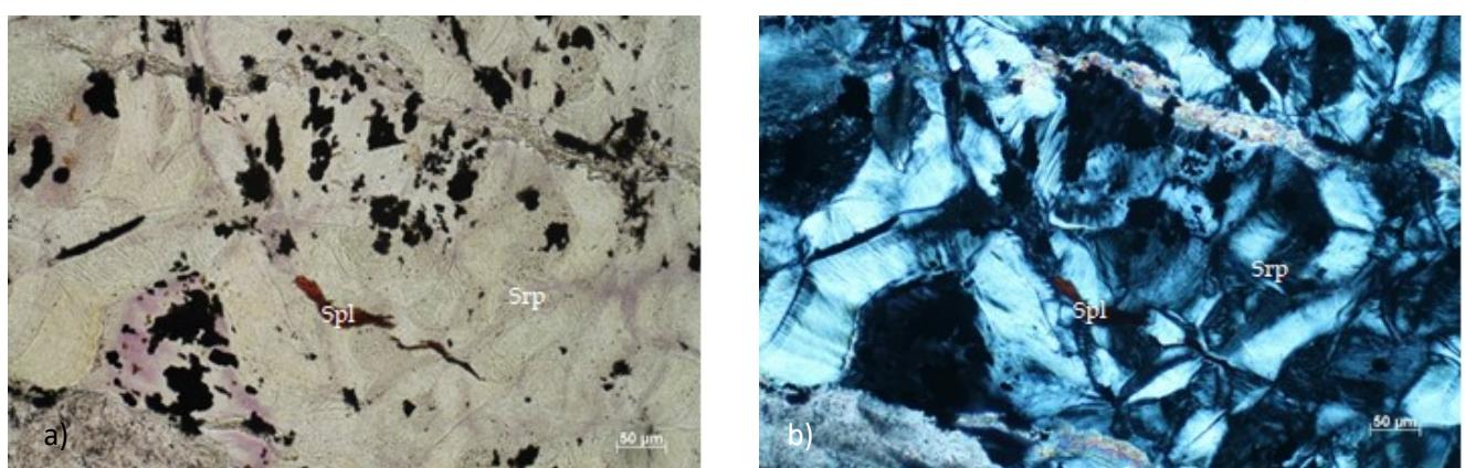
Slika 11. Mikroskopski uzorak Lojane 2 a) bez analizatora b) sa analizatorom (Spl- spinel, Srp- serpentin)
