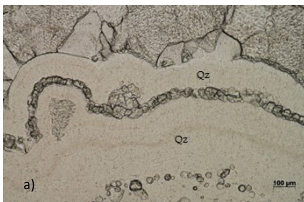
Slika 10. Mikroskopski uzorak Lojane 1 a) bez analizatora b) s analizatorom (za kratice vidjeti sliku 8); vidljiva krustifikacija
