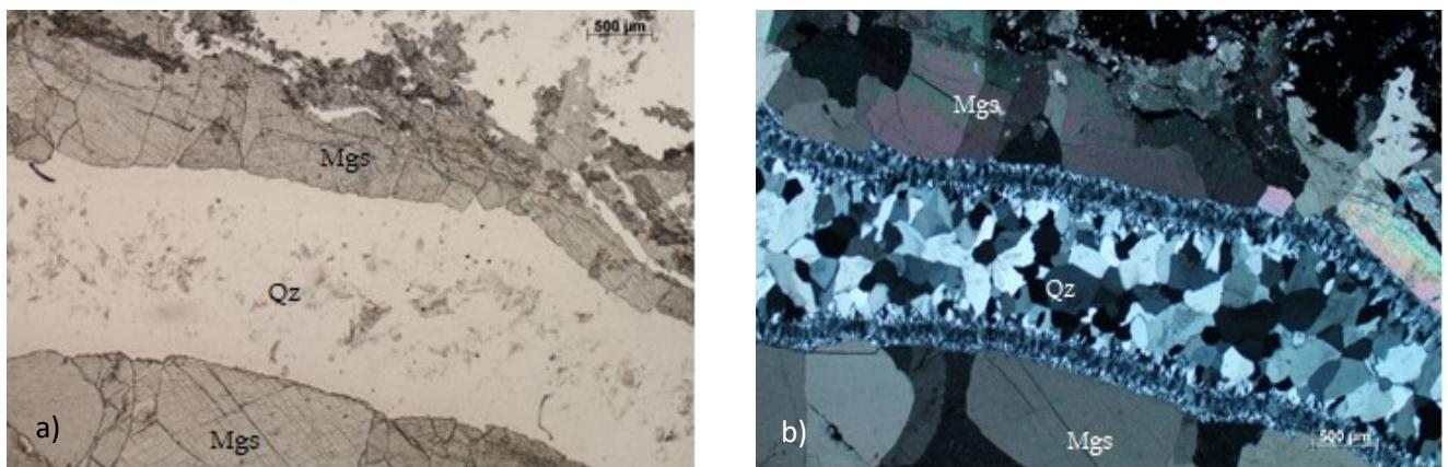
Slika 8. Mikroskopski uzorak Lojane 1 a) bez analizatora b) s analizatorom ( Qz-kremen, Mgs- magnezit); Vidljiva simetrična teksura
