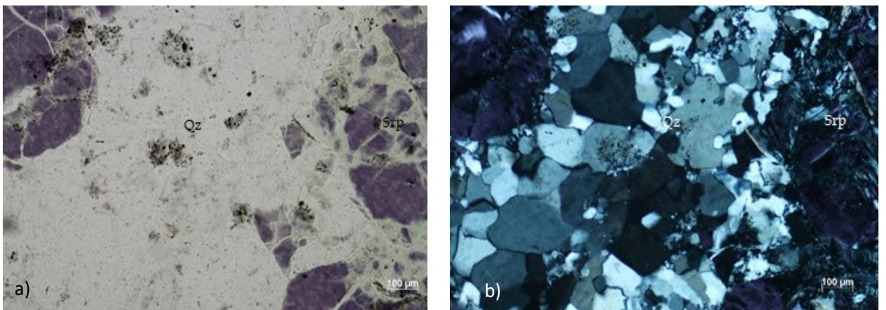
Slika 18. Mikroskopski uzorak Lojane 4 a) bez analizatora b) sa analizatorom (Kratice vidi sliku 8 i sliku 11)
