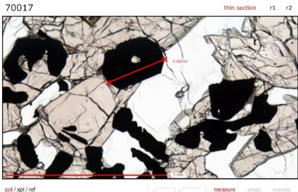
Slika 27: The Open University Microscope s alatom za mjerjenje veličine zrna
