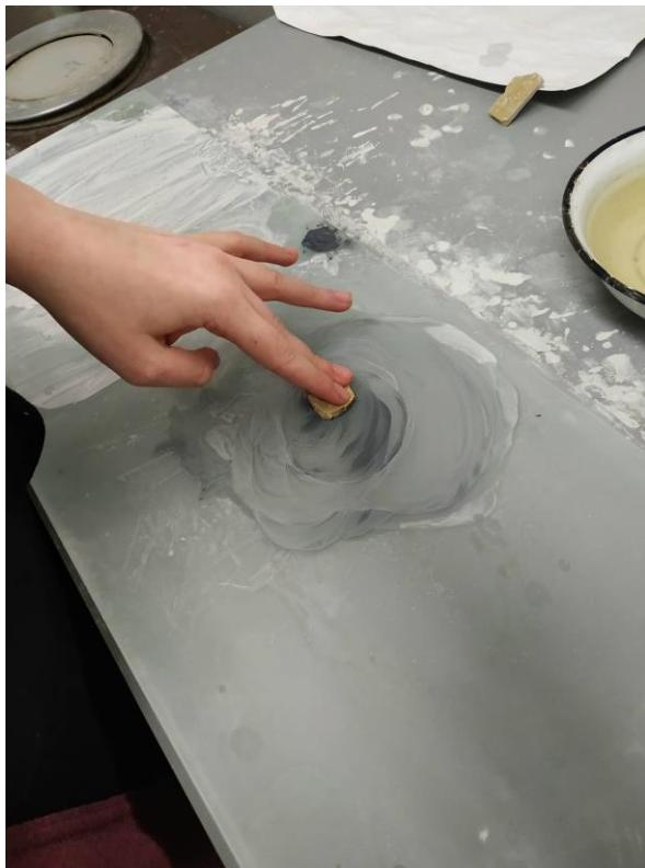
**Slika 8.** Poliranje pločice na „brusnoj“ plohi (vlastita fotografija).
