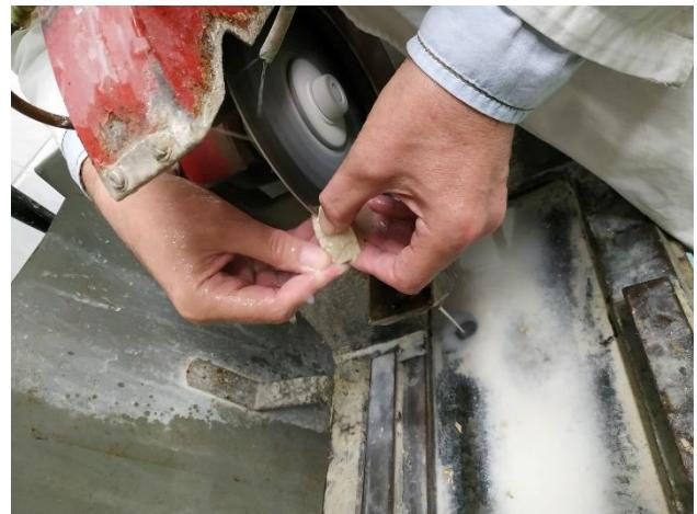
**Slika 7.** Oblikovanje pločica na dijamantnoj pili (vlastita fotografija).
