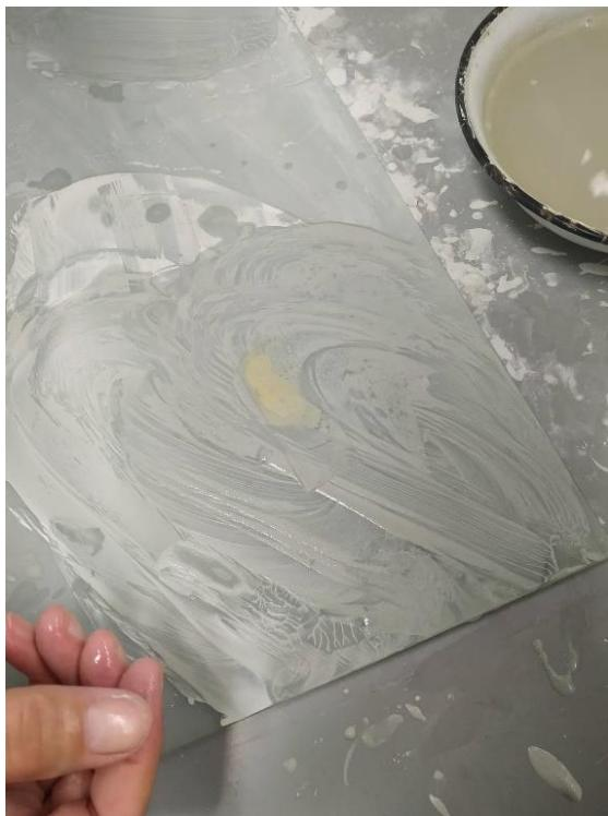
**Slika 12.** Završno poliranje mikroskopskog preparata (vlastita fotografija).
