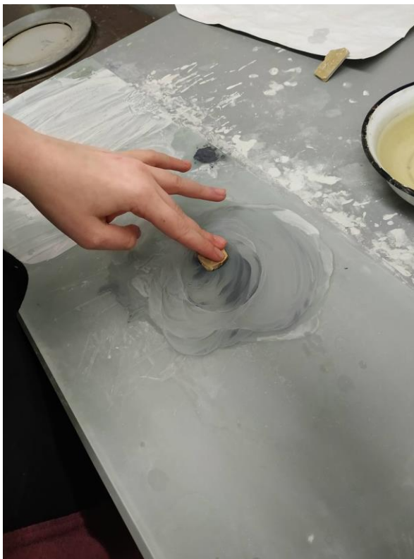
Slika 8. Poliranje pločice na „brusnoj“ plohi (vlastita fotografija).
