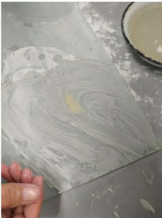
Slika 12. Završno poliranje mikroskopskog preparata (vlastita fotografija).
