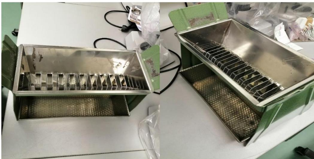
Slika 5. Mikrospliter korišten za standardizaciju uzoraka.
