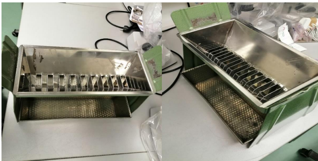
Slika 5. Mikrospliter korišten za standardizaciju uzoraka.
