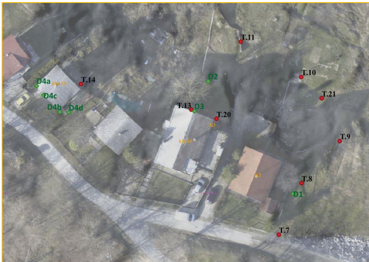
Slika 32. Čelo klizišta sa stambenim objektima (narančasto) na kojima su se vršila mjerenja (zelene točke). Crvenim točkama su označene terenske točke pregleda terena.
