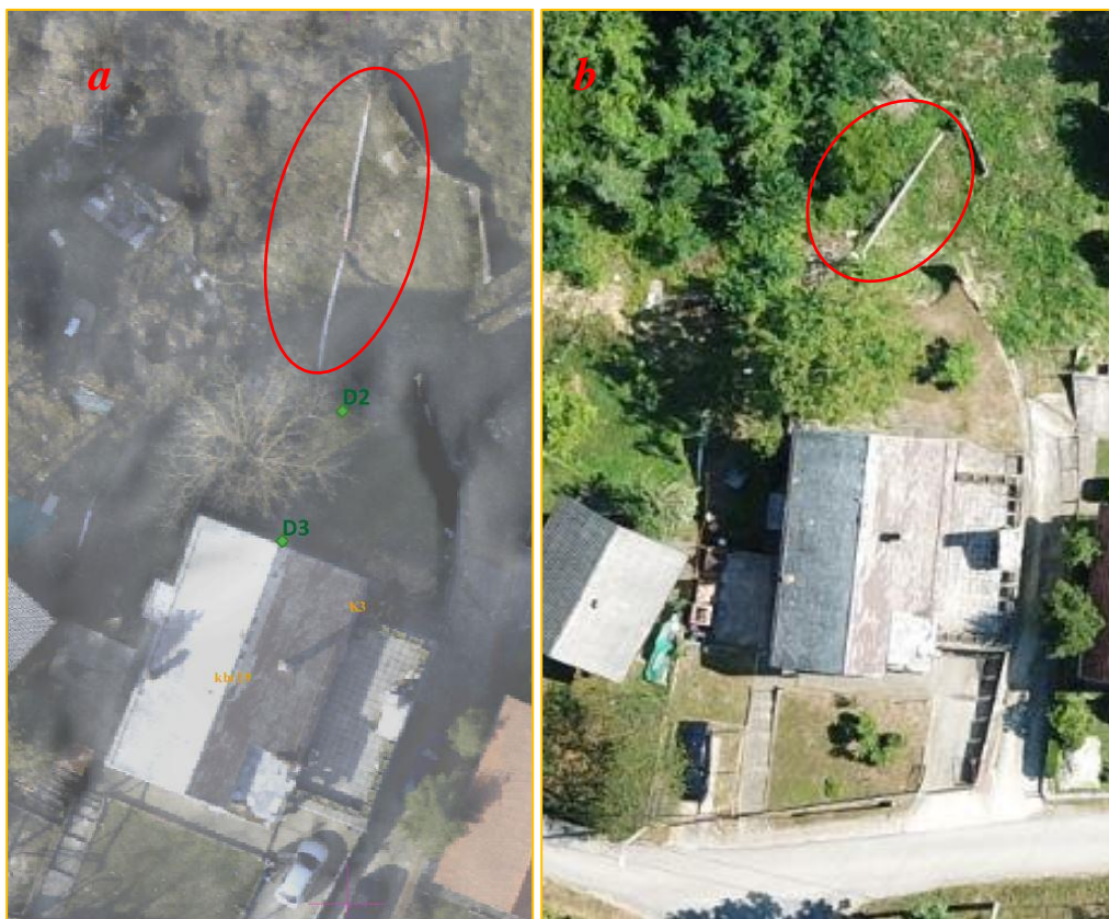
Slika 37. Usporedba ortofotografije iz 2018 godine (a) i snimke iz drona 2020 godine (b). Kružnicom su označene cijevi i vidljiva je promjena u položaju (azimutu) cijevi.
