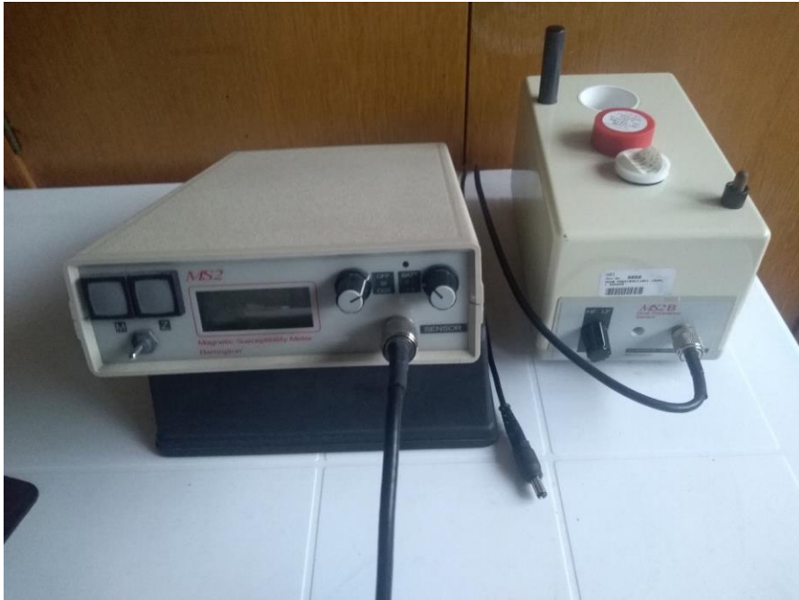
Slika 10. Magnetometar „Bartington MS2“ i senzor „MS2B“
