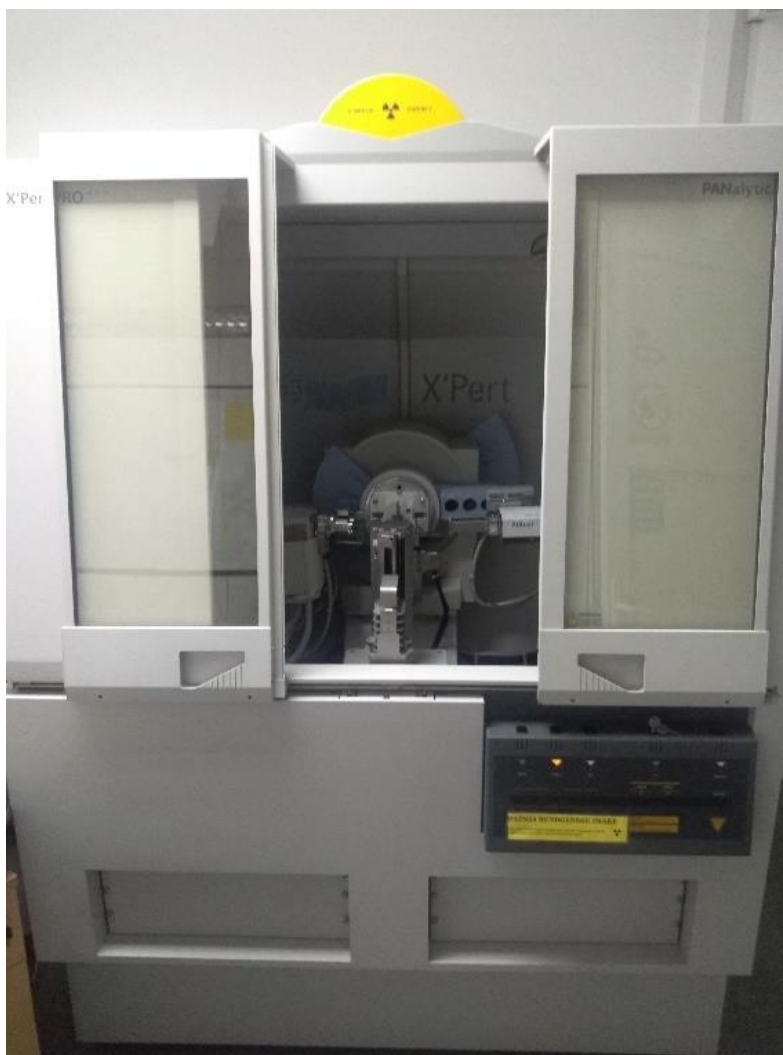
Slika 9. Fotografija rendgenskog difraktometra „PANalytical X'Pert Powder“
