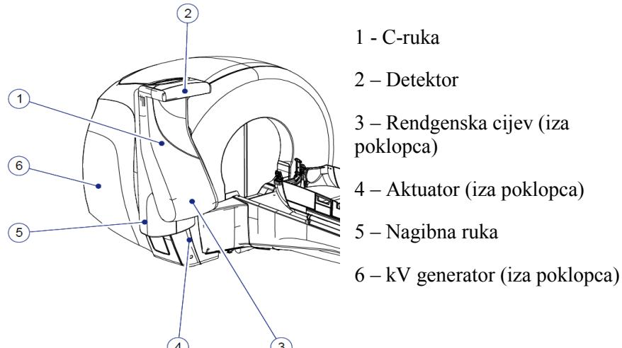
Slika 7.2: dijelovi CBCT sustava, preuzeto iz [25].
