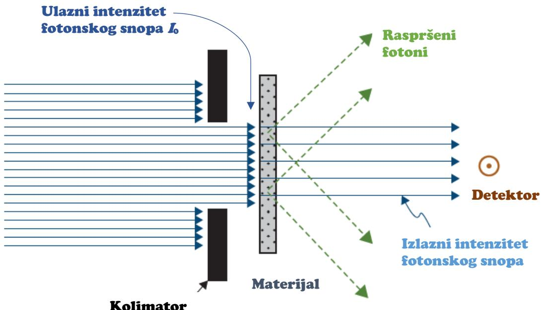
Slika 3.10: eksperimentalni postav za mjerjenje atenuacije uskog fotonskog snopa početnog intenziteta  $I_0$ , preuzeto iz [2].
