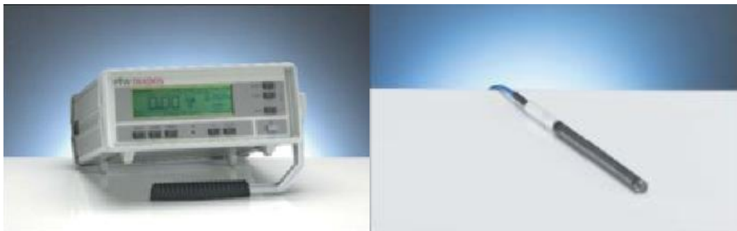
Slika 7.3: lijevo-elektrometar T11003 DIADOS, desno-ionizacijska komorica PTW 30009, preuzeto iz [26].
