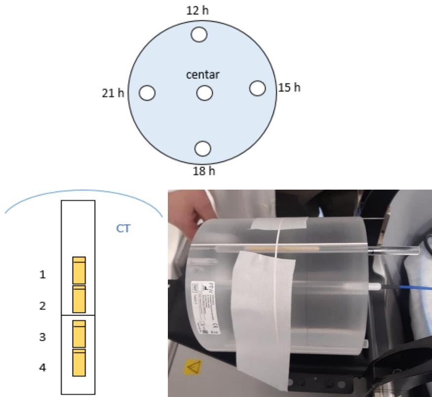
Slika 7.6: gore – položaj otvora u PMMA CT fantomu. Dolje lijevo - skica položaja i orientacije dozimetara tijekom mjerena. Dolje desno – smještaj dozimetra unutar fantom prilikom mjerena.
