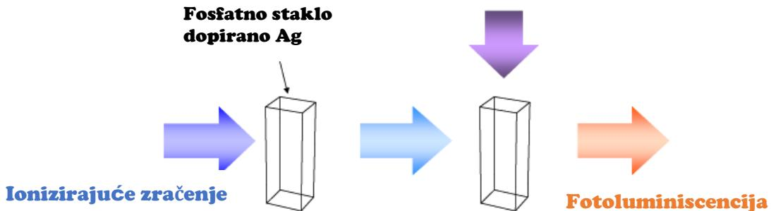
Slika 5.2: shematski prikaz radiofotoluminiscencije, preuzeto iz [17].
