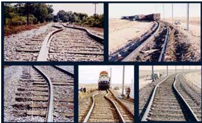
Slika 18. Izobličenje na tračnicama zbog zagrijavanja<sup>55</sup>
