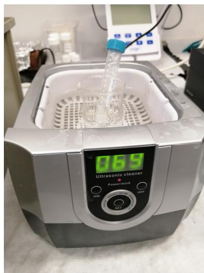
Slika 2.12: Ultrazvučna kupelj
