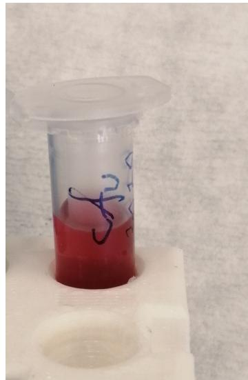
Slika 2.15: Eppendorf epruveta s koloidom zlatnih nanočestica
