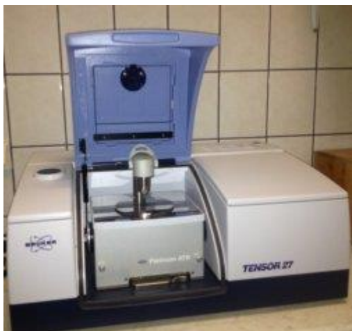
Slika 2: Bruker Tensor 27, ATR spektrometru (Internetski izvor 2)
