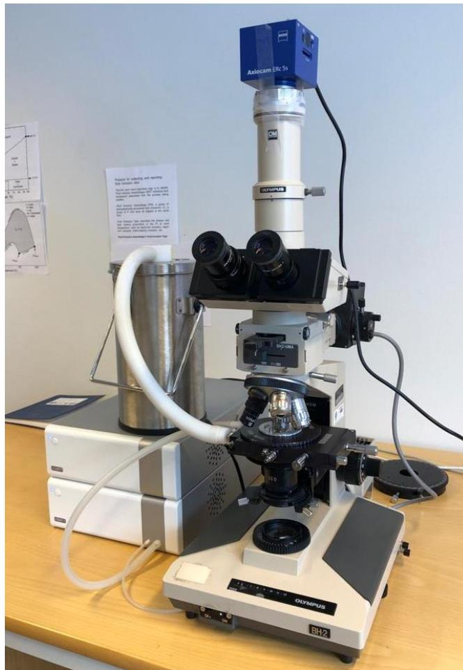
**Slika 12.** Mikroskop s komoricom (Linkam THMS 600 )za mikrotermometrijska mjerena koristen tijekom izrade rada
